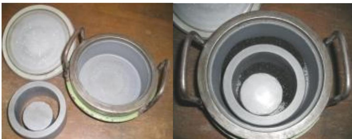
Figura 4.4 – Detalhes da panela sem e com amostra de CAG.
