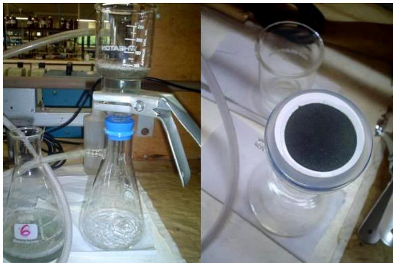
Figura 4.8 – Procedimento de filtração dos carvões ativados e carvão retido na membrana.
