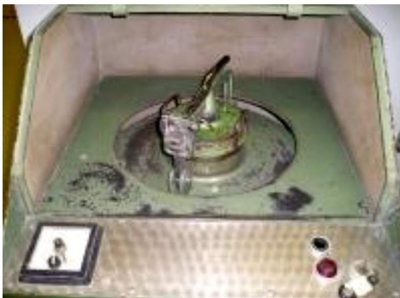
Figura 4.3 – Moinho utilizado na pulverização das amostras de CAG.
