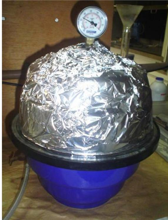
Figura 4.5 – Dessecador acoplado a bomba a vácuo.
