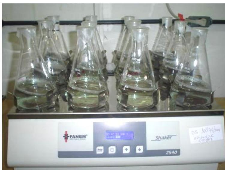
Figura 4.7 – Agitador horizontal da Marca FANEM (Modelo 2540) utilizado para agitação das amostras durante os experimentos para obtenção das isotermas.
