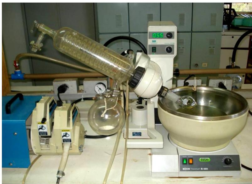
Figura 4.14 – Procedimento de secagem das amostras extraídas
