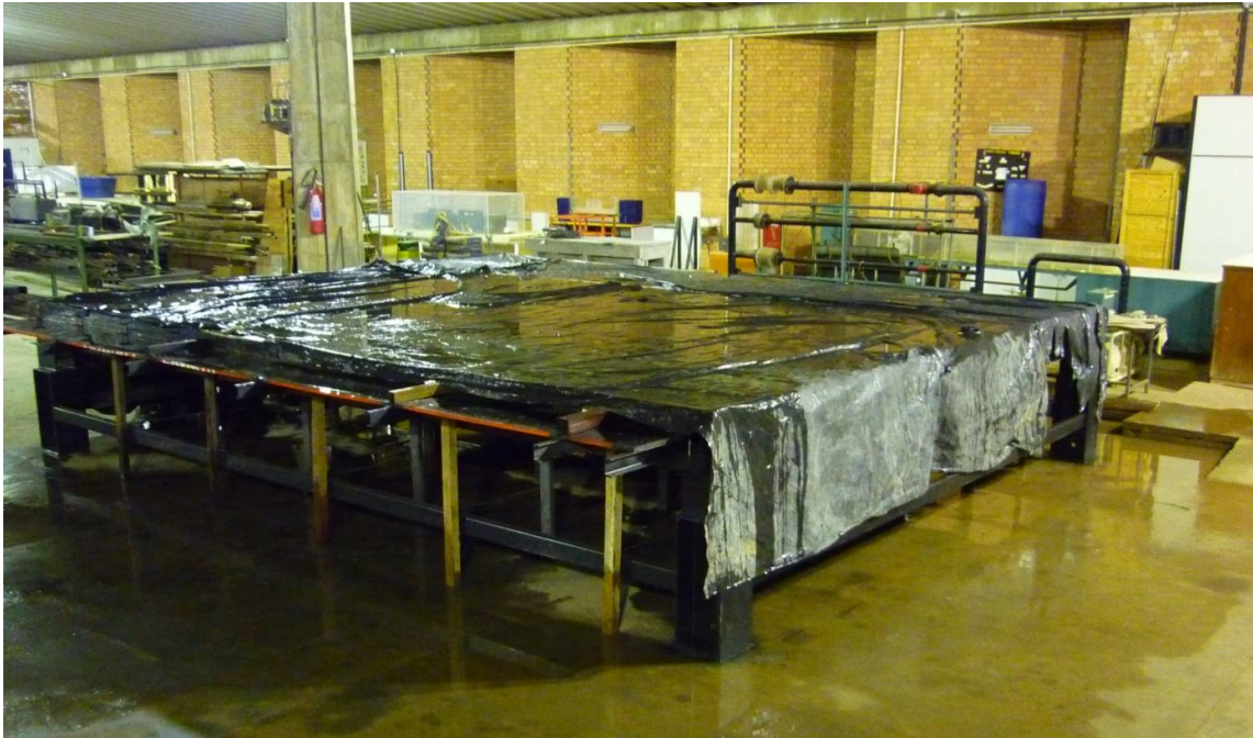
Figura 5-10. – Processo de cura na plataforma, com utilização de plástico.
