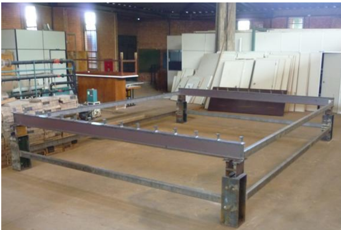
Figura 5-2. – União do quadro superior entre os perfis de aço tipo U de 4 polegadas, perfis tipo W 200x19,3 e conectores de cisalhamento tipo U.
