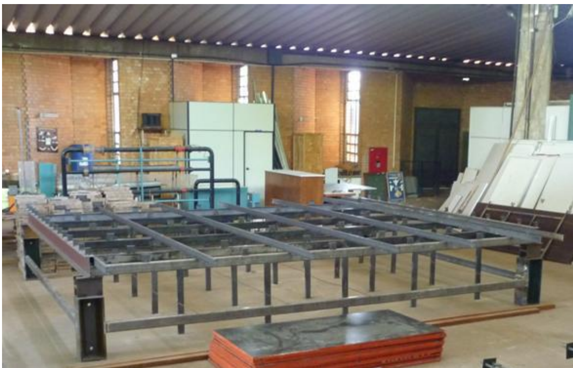
Figura 5-3. – Escoramento metálico da plataforma de ensaios dinâmicos.
