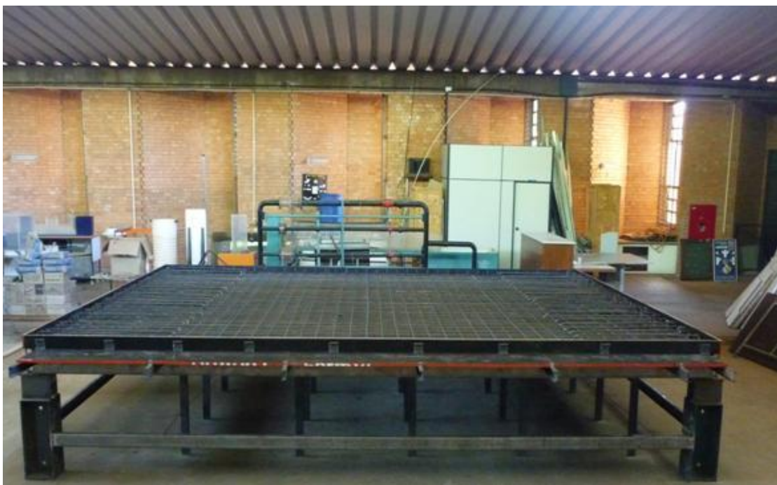
Figura 5-5. – Armadura da plataforma de ensaios dinâmicos instalada.
