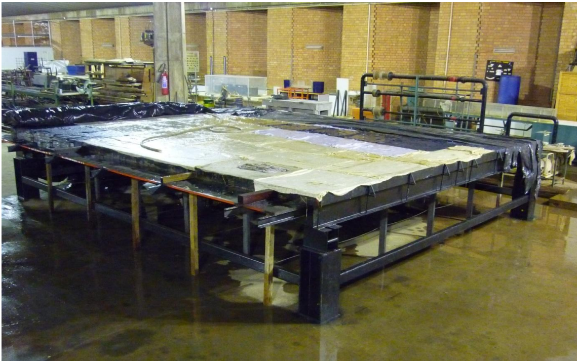
Figura 5-9. – Processo de cura na plataforma, com utilização de panos.
