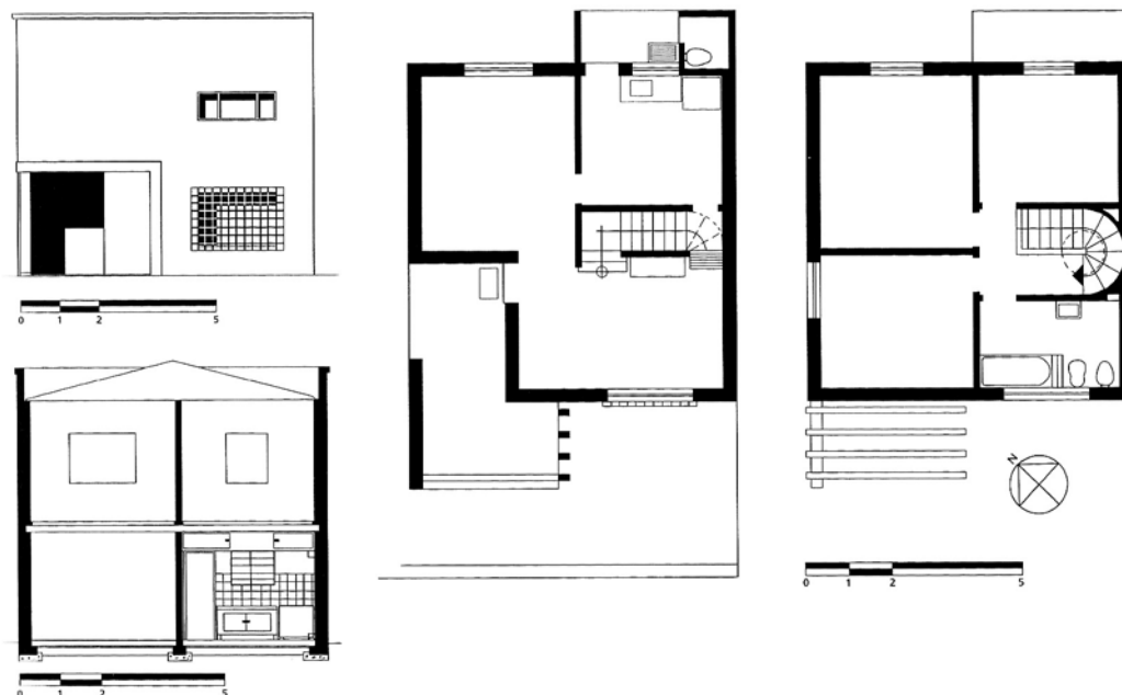
67. Residência Giulio Pasquale - Vilanova Artigas, São Paulo, 1939 | fachada, corte e plantas. Fonte: Adriana Irigoyen (2002)
