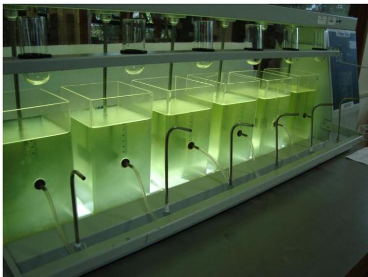
Figura 4.1 – Ensaio de sedimentação com células de *Cylindrospermopsis raciborskii* utilizando o teste de jarros.
