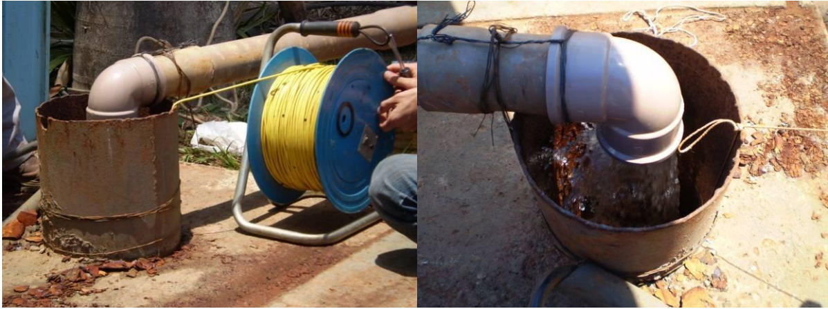
Figura 4.11 - Ensaio de Infiltração no Poço Paineiras – 11 horas de injeção contínua. Detalhe para medidor manual de nível, utilizado em todos os ensaios.
