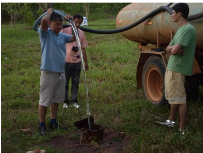
Figura 4.6 - Ensaio de infiltração no Poço SESI II, com água potável transportada por caminhão tanque.
