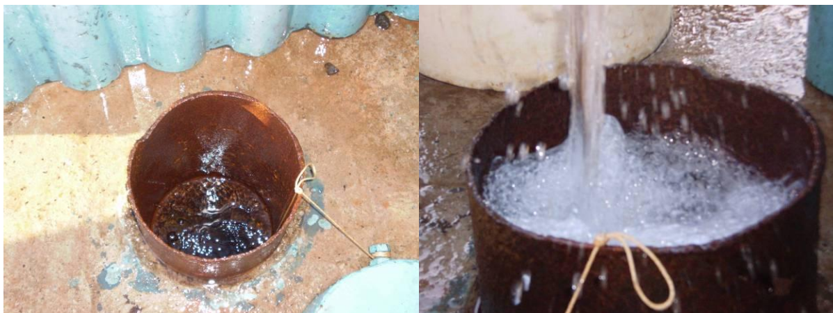
Figura 4.8 - Ensaio de Infiltração no Poço SESI I, com rápida saturação do poço.
