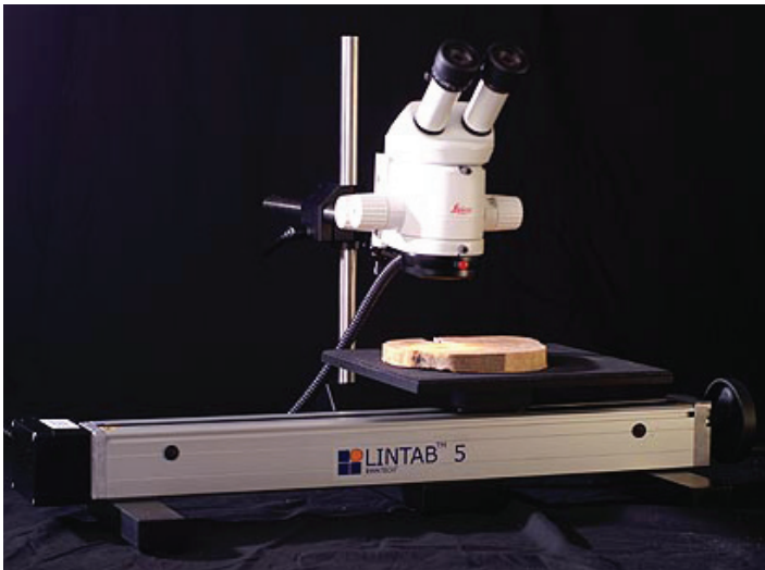
Figura 5. Instrumento Lintab. Fuente: www.rinntech.com
