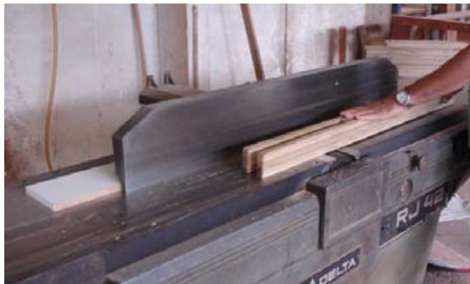
Figura 96: Nivelamento das superfícies dos elementos compostos na desempenadeira. Fonte: Foto da autora.
