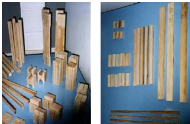
Figura 59: Amostras de bambu para ensaio de resistência mecânica. Fonte: GONÇALVES et. al. , 2000, p.02.
