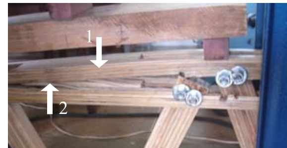
6. Afastamento nas fibras do bambu (1) e ruptura na linha de cola (2).
