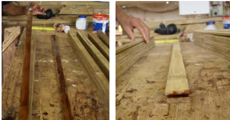
Figura 88: Aplicação do adesivo e alinhamento das lâminas. Fonte: Fotos da autora.
