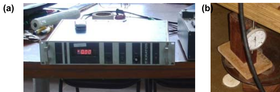
Figura 101: (a) Medidor portátil e (b) extensômetro já posicionado na estrutura. Fonte: Fotos da autora.
