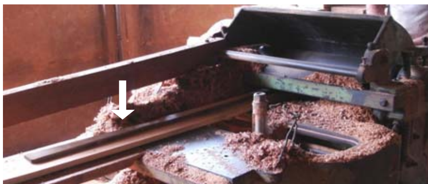
Figura 86: Saída da lâmina da plaina desengrosso de 1 face - retirada da casca. Fonte: Foto da autora.
