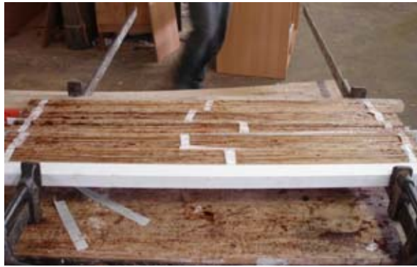
Figura 90: Recursos para facilitar o processo de prensagem do material. (Lâminas na prensa ainda sem o trilho de pressão central) Fonte: Foto da autora.
