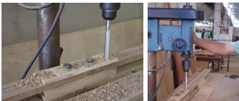
Figura 97: Método de perfuração com gabarito usado na furadeira de bancada. Fonte: Fotos da autora.
