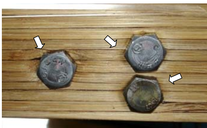
Figura 107: Fibras do bambu esmagadas pela cabeça dos parafusos. Fonte: Foto da autora.
