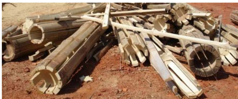
Figura 83: Colmos da espécie Dendrocalamus giganteus após passarem pela serra de discos duplos. Fonte: Foto da autora.
