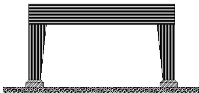
PÓRTICO COM ESTRUTURA LAMINADA
