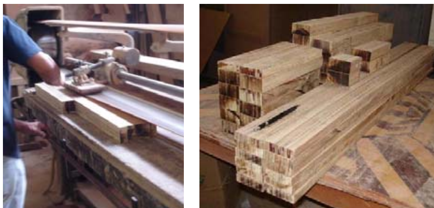
Figura 94: Peças na lixadeira elétrica e já prontas com os primeiros acabamentos. Fonte: Fotos da autora.
