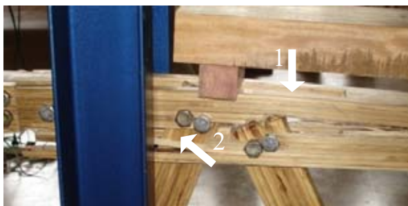
5. Afastamento das fibras do bambu (1) e ruptura na linha de cola (2) - face posterior.
