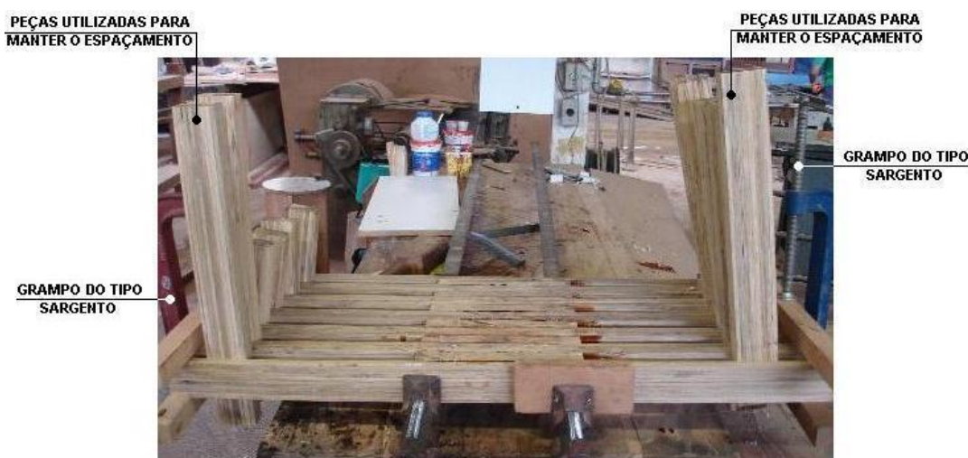
Figura 95: Elementos compostos na prensa a frio. Fonte: Foto da autora.
