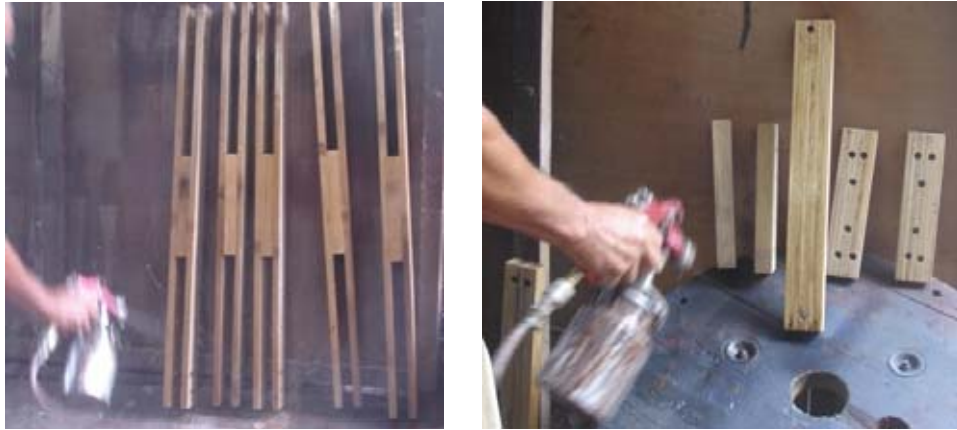
Figura 99: Acabamento final com a aplicação do selador. Fonte: Fotos da autora.
