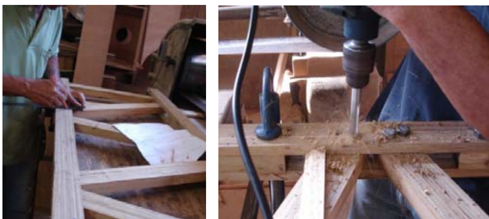
Figura 98: Marcação das aberturas e posterior perfuração com a furadeira elétrica manual. Fonte: Fotos da autora.
