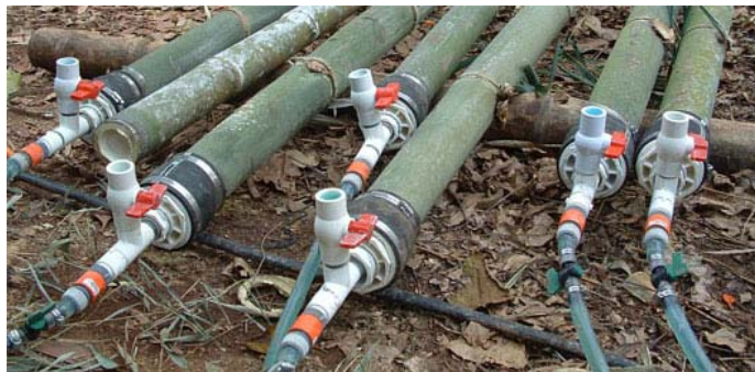
Figura 24: Método Boucherie para o tratamento dos bambus. Fonte: www.bambutico.com .
