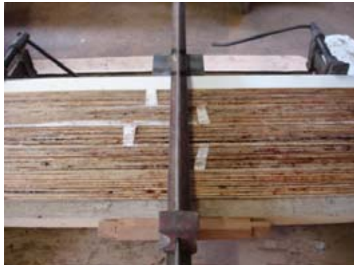
Figura 89: Lâminas na prensa a frio do tipo trilho-sargento. Fonte: Foto da autora.
