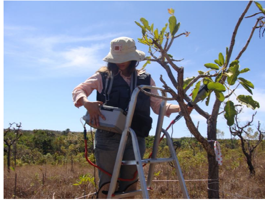
Figura 3. Medição das trocas gasosas foliares de um indivíduo adulto de Tabebuia aurea utilizando-se o analisador de gás por infravermelho portátil (IRGA).
