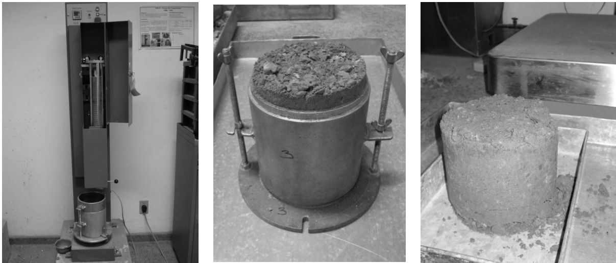
Figura 3-19. Compactador mecânico e corpo de prova de RCD após compactação Proctor
