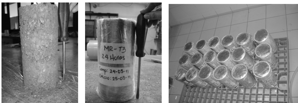
Figura 3-24. Procedimento de armazenagem e cura dos corpos de prova de RCD
