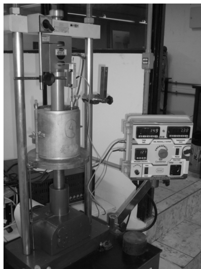
Figura 3-20. Equipamento usado na penetração do ensaio CBR sobre RCD
