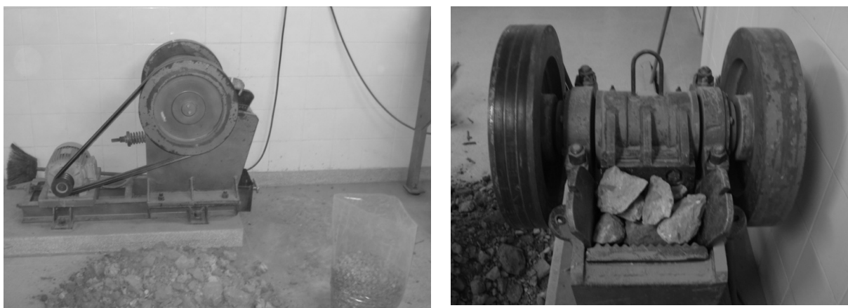
Figura 3-7. Processo de britagem secundário
