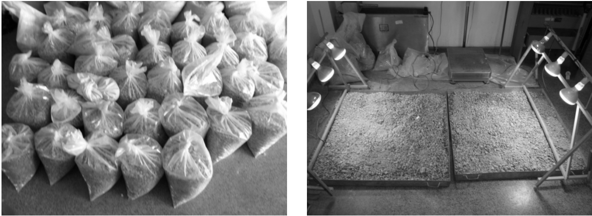
Figura 3-8. Processo de armazenamento e secagem do RCD
