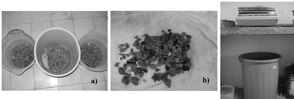
Figura 3-11. Ensaio de absorção e densidade aparente do agregado graúdo de RCD: a) etapa de saturação 24 h; b) massa saturada superficialmente seca e c) massa saturada submersa
