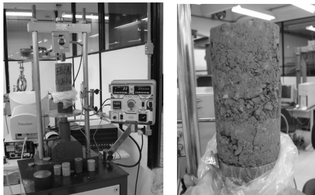
Figura 3-23. Prensa de compressão CBR e Marshal utilizada no ensaio de compressão simples
