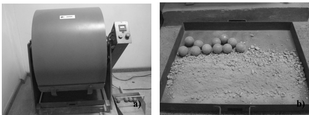
Figura 3-15. Ensaio de abrasão Los Angeles: a) equipamento; b) RCD após do ensaio
