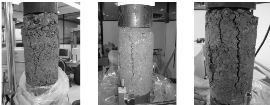
Figura 4-25. Processo de aparição de trincas longitudinais durante ensaio de compressão simples
