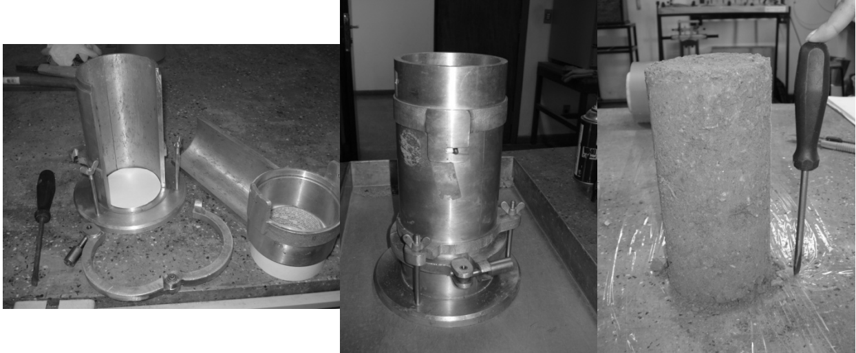
Figura 3-21. Molde tripartido e corpo de prova usado na realização de ensaios de módulo de resiliência
