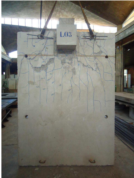
Figura 4.47 – Padrão de fissuração da face superior da laje – L3
