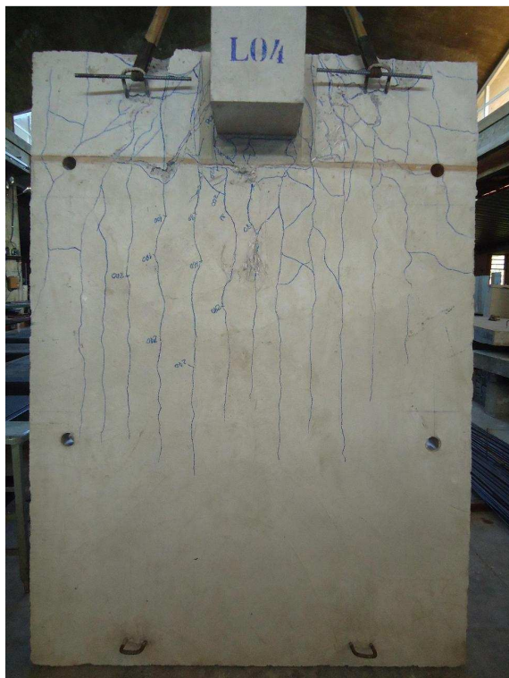
Figura 4.48 – Padrão de fissuração da face superior da laje – L4
