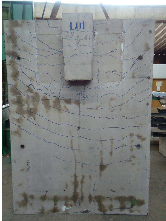
Figura 4.49 – Padrão de fissuração da face inferior da laje – L1
