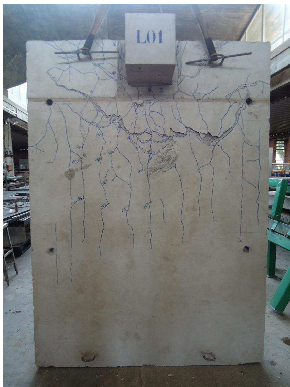
Figura 4.45 – Padrão de fissuração da face superior da laje – L1
