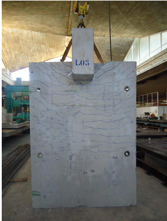
Figura 4.51 – Padrão de fissuração da face inferior da laje – L3
