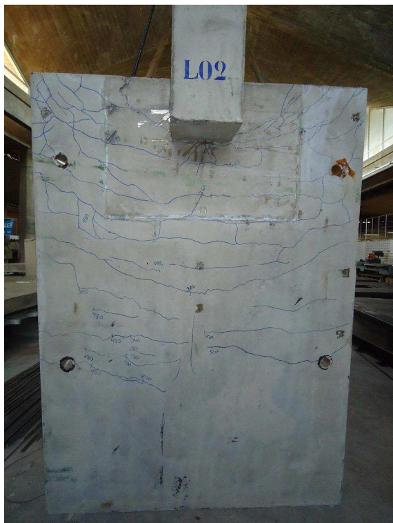
Figura 4.50 – Padrão de fissuração da face inferior da laje – L2
