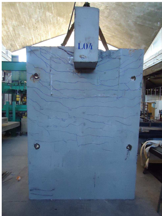
Figura 4.52 – Padrão de fissuração da face inferior da laje – L4
