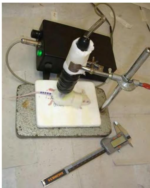
**Figura 04** - Equipamento I, unipolar, gerador de campo magnético alternado de alta frequência (1MHz).
