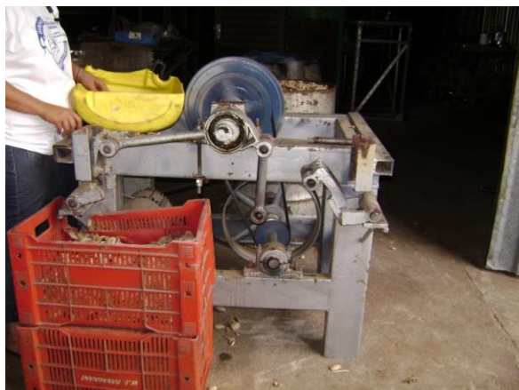
Figura 10 – Máquina elétrica de despolar e quebrar o fruto do baru Fonte: Nonna Pasqua (2010).
