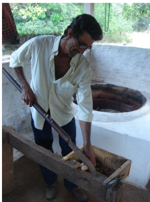
Figura 9 – Dispositivo manual para extração da amêndoa do baru Fonte: Fotos do autor (2010).
