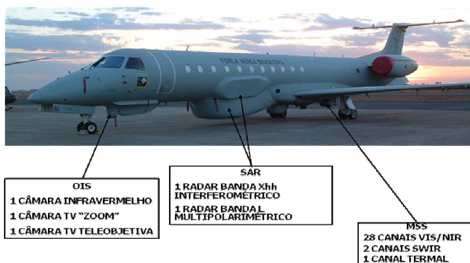
Figura 3-5 - Localização dos sensores do R-99
