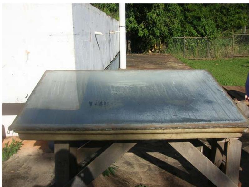
Figura 9. Visão frontal do equipamento – Destilador solar
