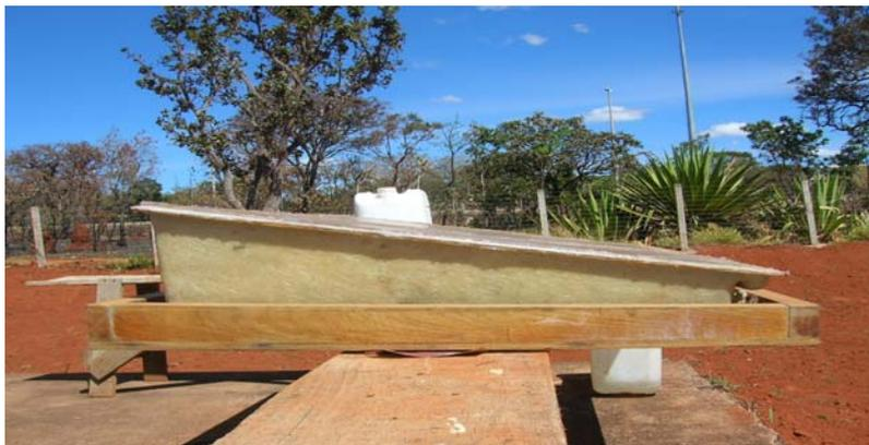
Figura 10. Visão lateral do equipamento – Destilador solar
