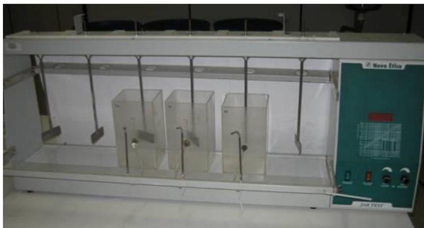
Figura 4.6 - Foto do equipamento de Teste de Jarros.
