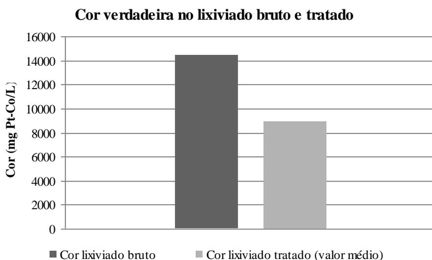
Figura 5.10 – Valores de cor verdadeira no lixiviado bruto e no lixiviado tratado com precipitação química com reagentes MgCl<sub>2</sub> e Na<sub>2</sub>HPO<sub>4</sub>; remoção média igual a 30%.
