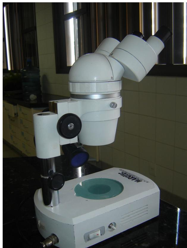
**Figura 9 - Lupa estereoscópica**
