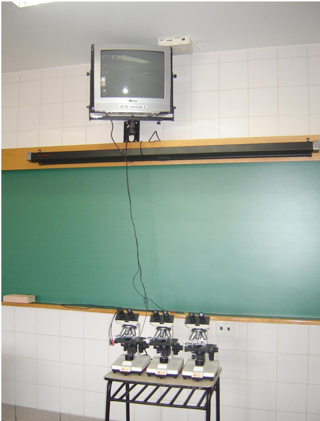
**Figura 3 - Monitor de vídeo acoplado ao microscópio óptico**
