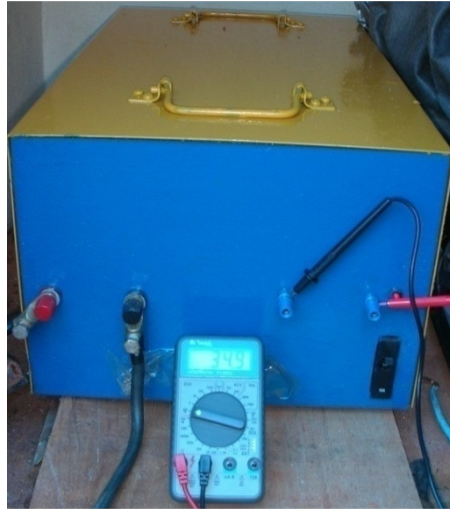
Figura 5.13 - Segunda versão da fonte de alimentação.
