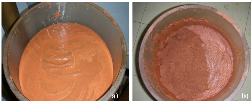
Figura 7.31 - Ganho de resistência pelo método eletrocinético. Antes (a) e após (b) o ensaio EO.
