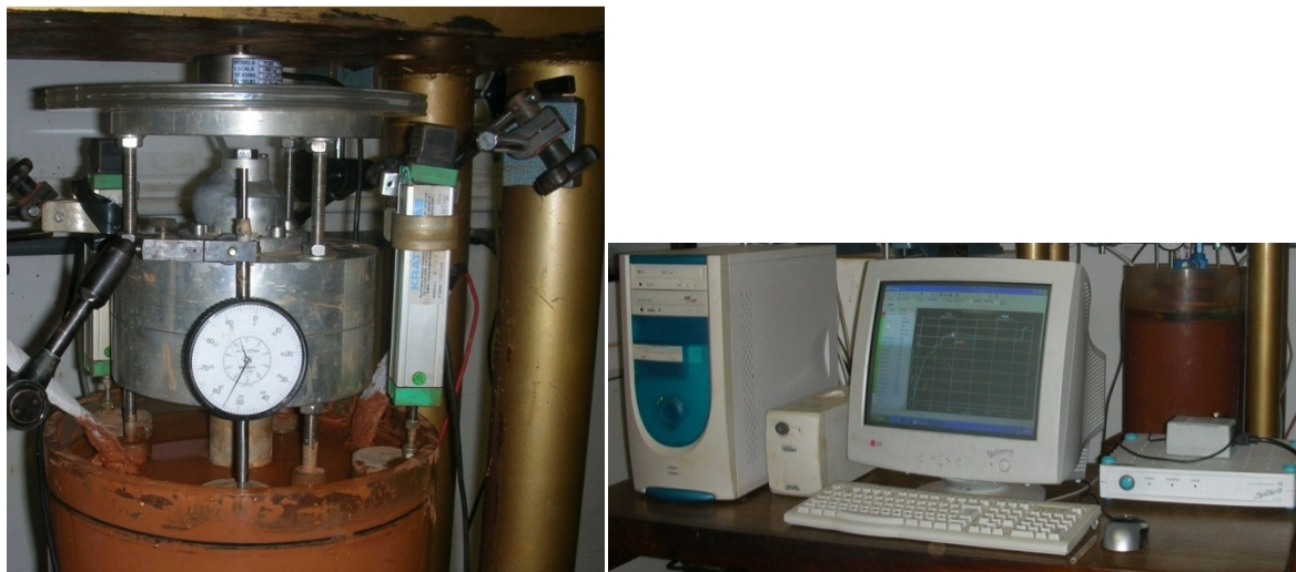
Figura 6.4 - Monitoramento do recalque com sistema de aquisição de dados - LVDT.
