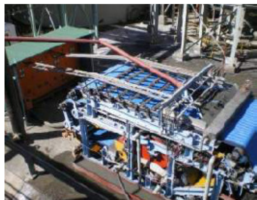
Figura 4.14 - Conceito do modelo de prensa de correia. A correia superior é o anodo e a inferior é o catodo (Lamont-Black et al, 2006a).
