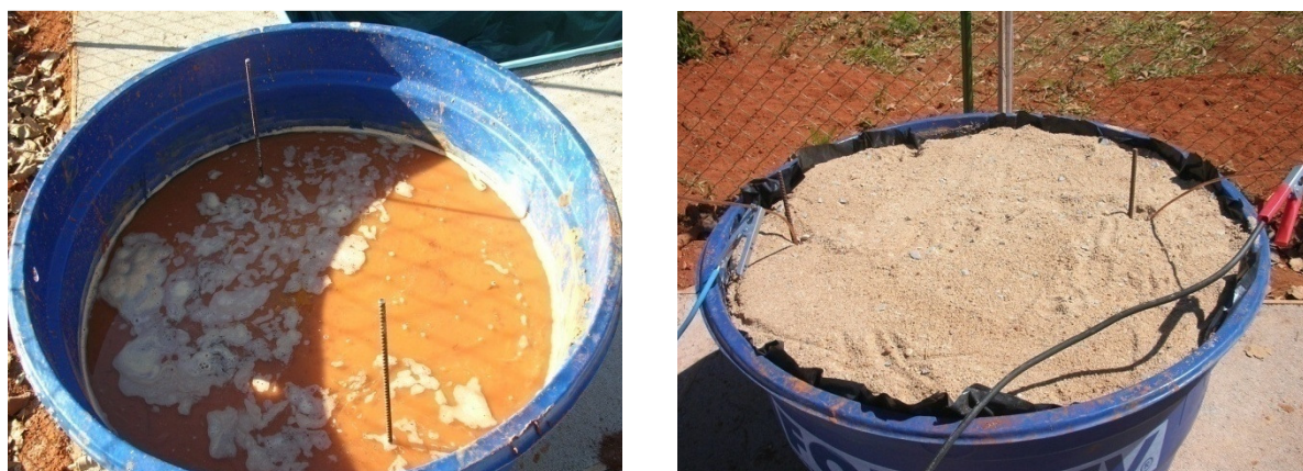
Figura 6.9 - Solo mole dentro do reservatório (esquerda) e sobrecarga com eletrodos (direita).
