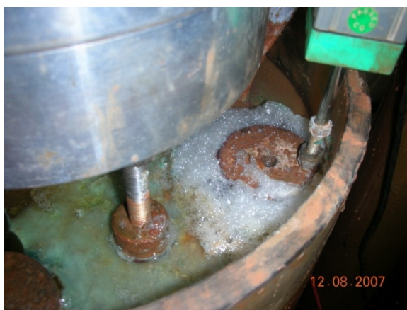
Figura 7.25 - Bolhas de ar e água esverdeada com a execução do ensaio.
