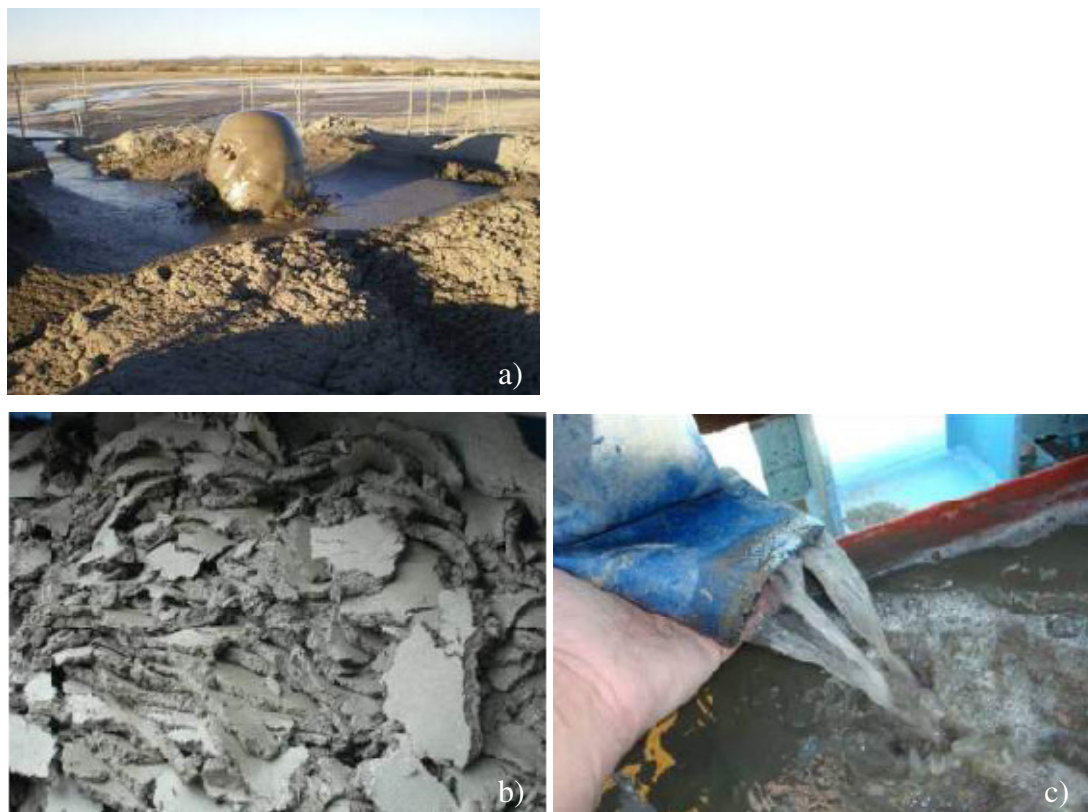
Figura 4.15 - Disposição do lodo de Kimberlite (a), secagem do rejeito (b) e recuperação da água (c). (Jones et al. , 2008)
