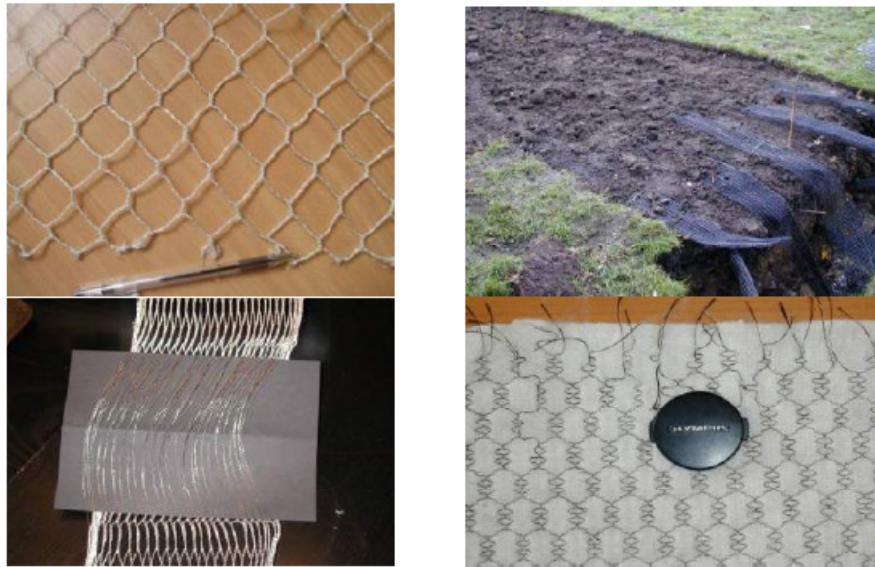
Figura 4.6 - Eletrodos GEC para condições planares (Jones et al. , 2008).
