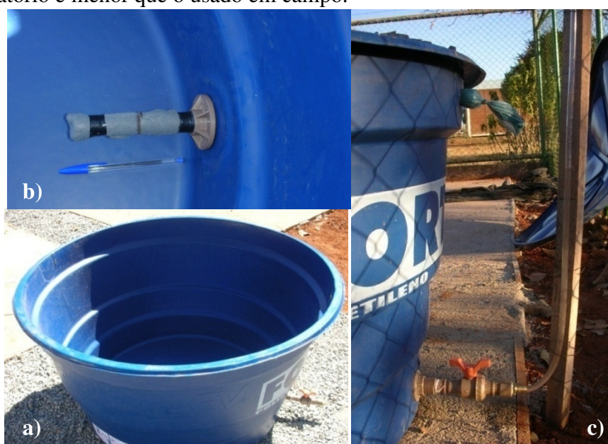
Figura 6.7 - Reservatório usado no ensaio teste (a), parte interna (b) e externa (c).
