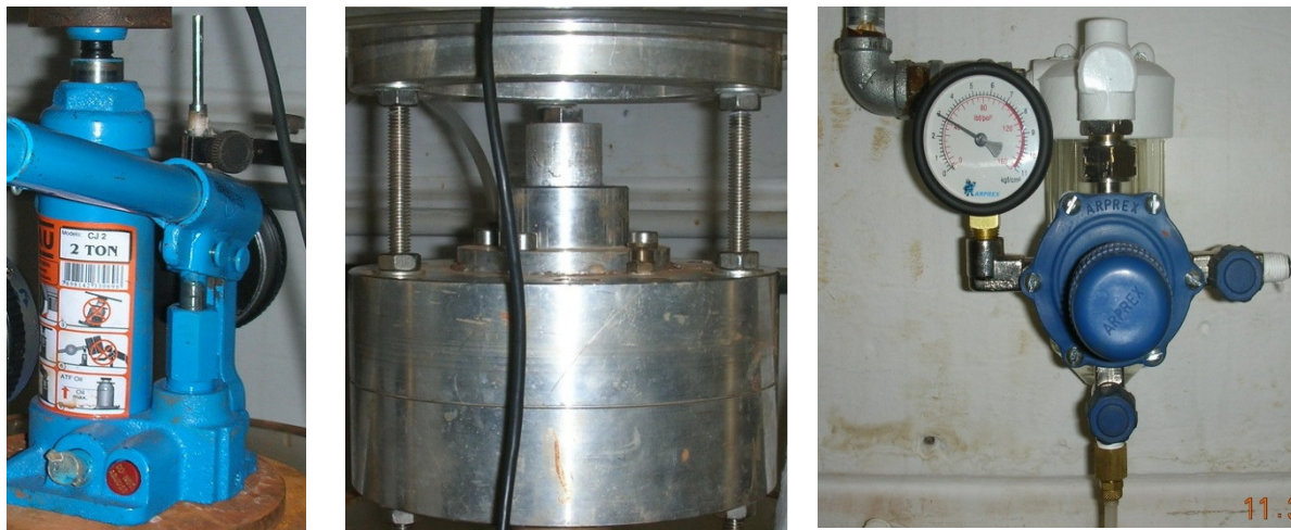
Figura 5.16 - Sistemas de carga aplicada no ensaio de laboratório: macaco hidráulico e câmara de compressão ligada ao sistema de ar comprimido.
