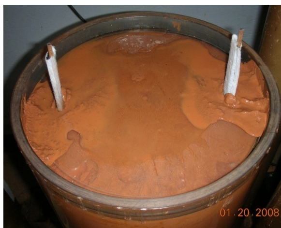
Figura 6.2 - Célula eletro-osmótica com tampa acrílica e DCEs inseridos.
