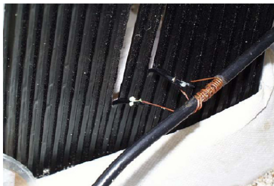
Figura 4.2 - DVE com dois fios de cobre no núcleo do plástico. (Chew et al. , 2004)
