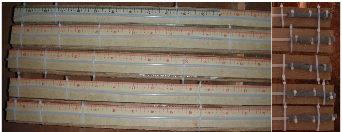
Figura 6.25 - Piezômetro para medir a poropressão na massa de solo.
