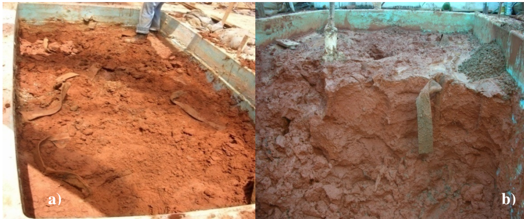
Figura 7.52 - Consistência do solo após os ensaios EO normal (a) e EO reversa (b).
