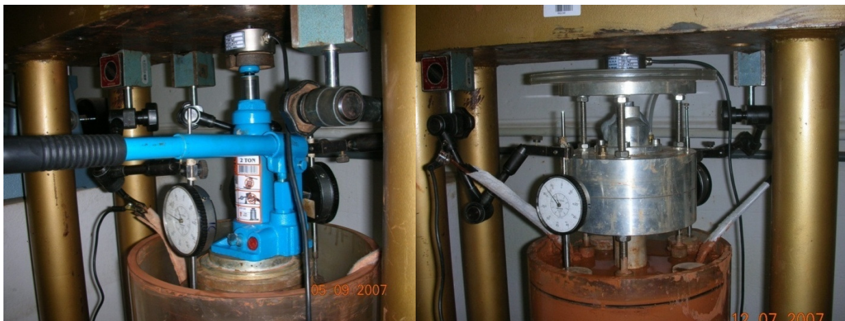
Figura 6.3 - Sistema de carregamento no solo, macaco hidráulico (a), câmara de compressão (b), e extensômetros para medição do recalque.
