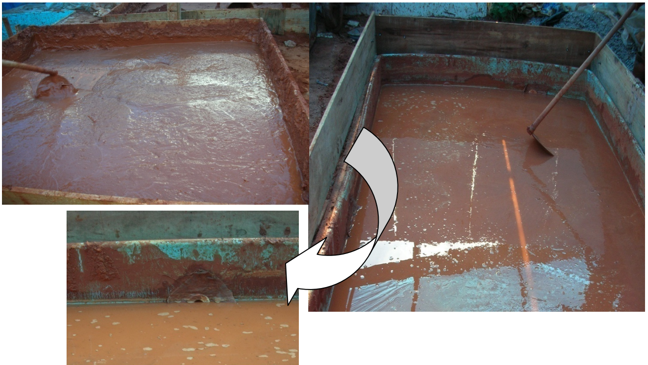
Figura 6.36 - Solo MD homogeneizado com lâmina d’ água na cota do tubo drenante.
