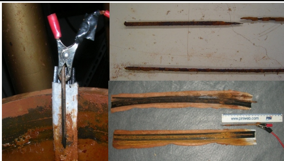
Figura 7.27 - Quebra do eletrodo de aço.
