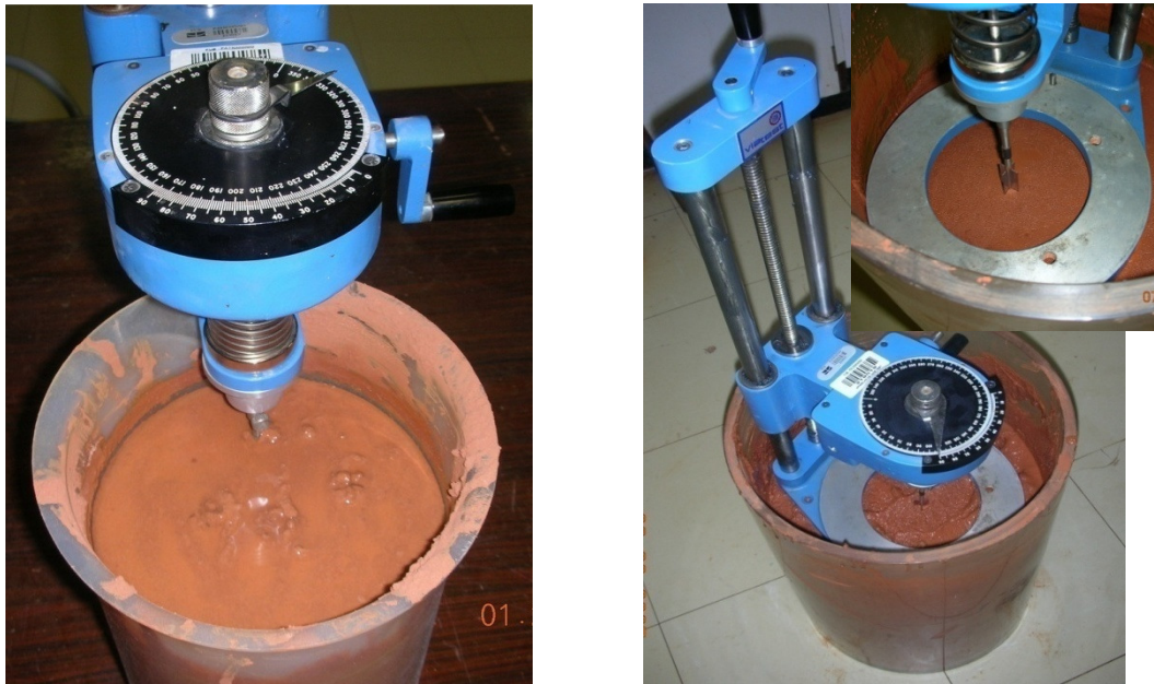
Figura 6.6 - Ensaio de resistência ao cisalhamento antes e após consolidação do solo.
