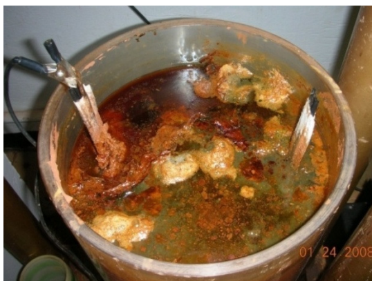
Figura 7.28 - Água drenada após a corrosão do eletrodo de aço.
