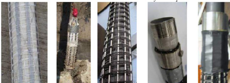
Figura 4.5 - Eletrodos GEC para misturas de pastas fluidas ou lamas (Jones et al. , 2008).
