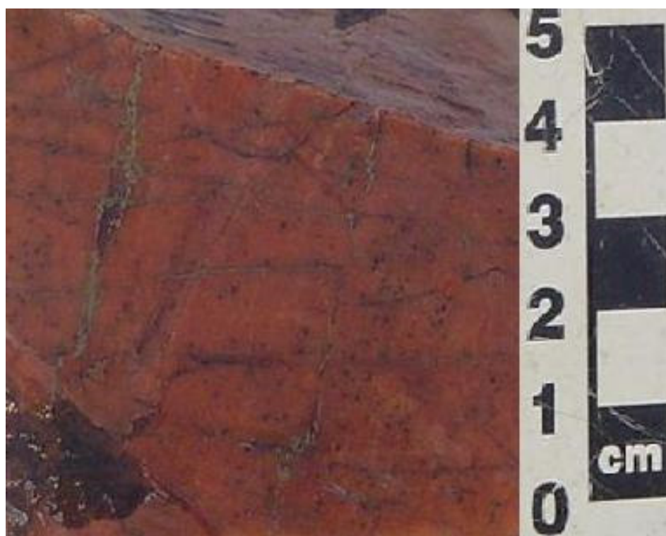
Figura 4.4 – Detalhe da figura anterior, onde se vê fraturamento ortogonal preenchido por epidoto.
