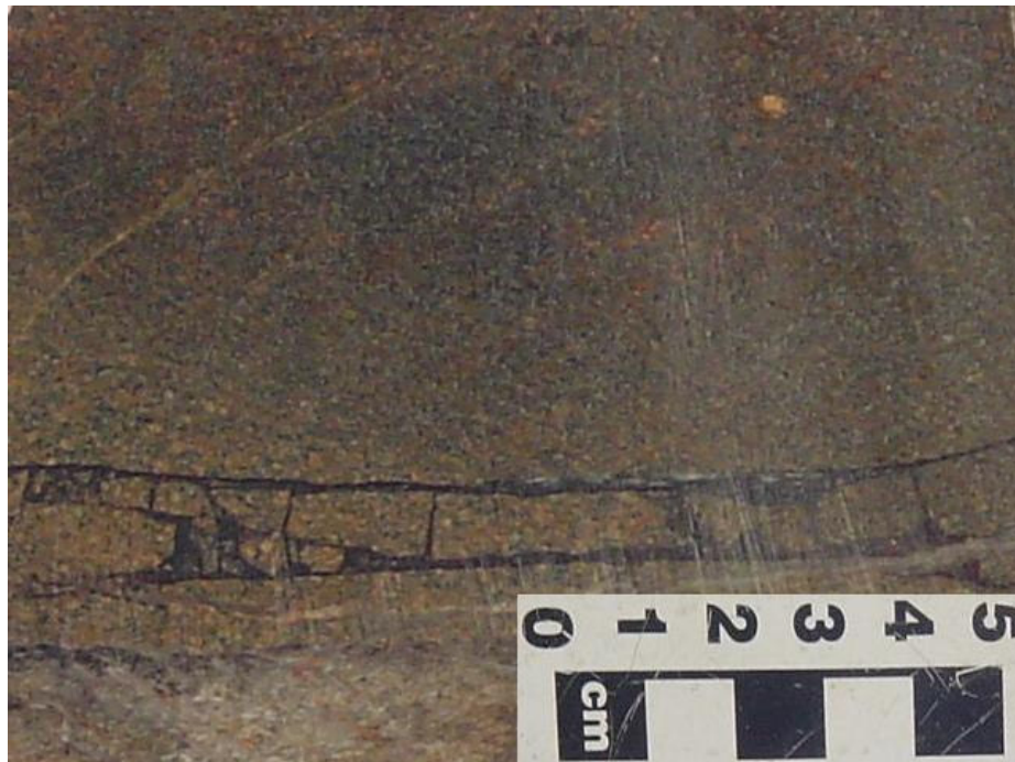
Figura 4.23 – Brecha de rocha vulcânica da Bacia de Cococí (MAG-27a), onde se vê a microestrutura fina e zona de fragmentação com preenchimento por óxidos (UTM 316878 E / 9293658 N).
