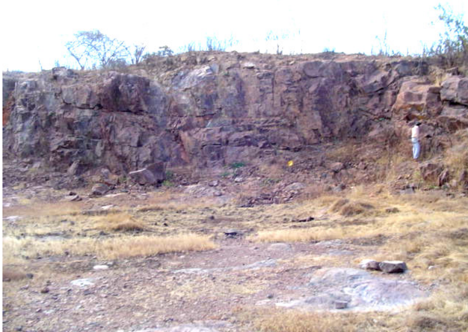
Figura 3.14 – Pedreira abandonada, às margens da BR-020, próxima a Parambú (CE), cuja rocha granítica foi explorada como agregado para a construção civil (Marcelo Leão, com. pess.) (UTM 315021 E / 9294336 N).
