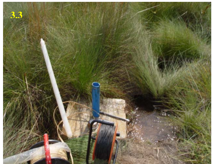
Figuras: 3.2 - Frasco de polietileno, utilizado para armazenar a amostra coletada, ao lado do piezômetro 27. 3.3 - Piezômetro 1, localizado em gleissolo, com nível freático aflorando. Ao lado do piezômetro 1 encontram-se um medidor de nível, um amostrador e um carretel para introduzir o amostrador no poço.
