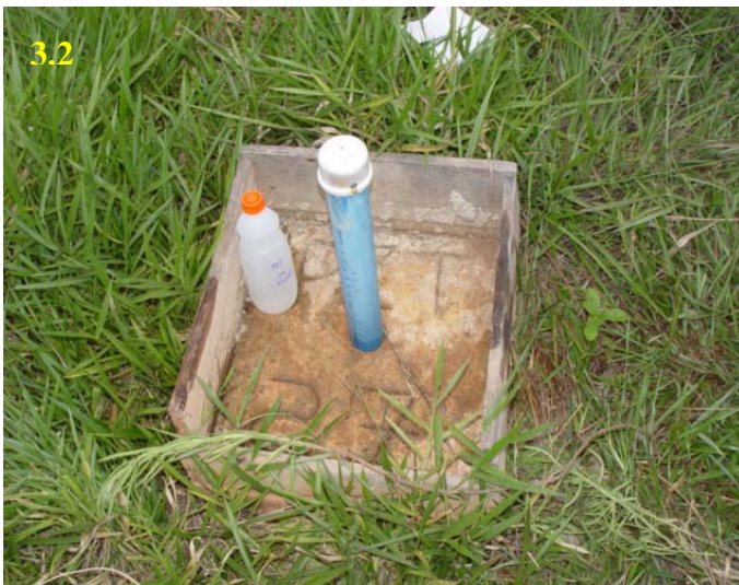
Figuras: 3.2 - Frasco de polietileno, utilizado para armazenar a amostra coletada, ao lado do piezômetro 27. 3.3 - Piezômetro 1, localizado em gleissolo, com nível freático aflorando. Ao lado do piezômetro 1 encontram-se um medidor de nível, um amostrador e um carretel para introduzir o amostrador no poço.
