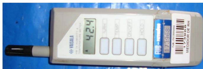
Figura 4.30: Aparelho medidor de temperatura e umidade relativa do ar
