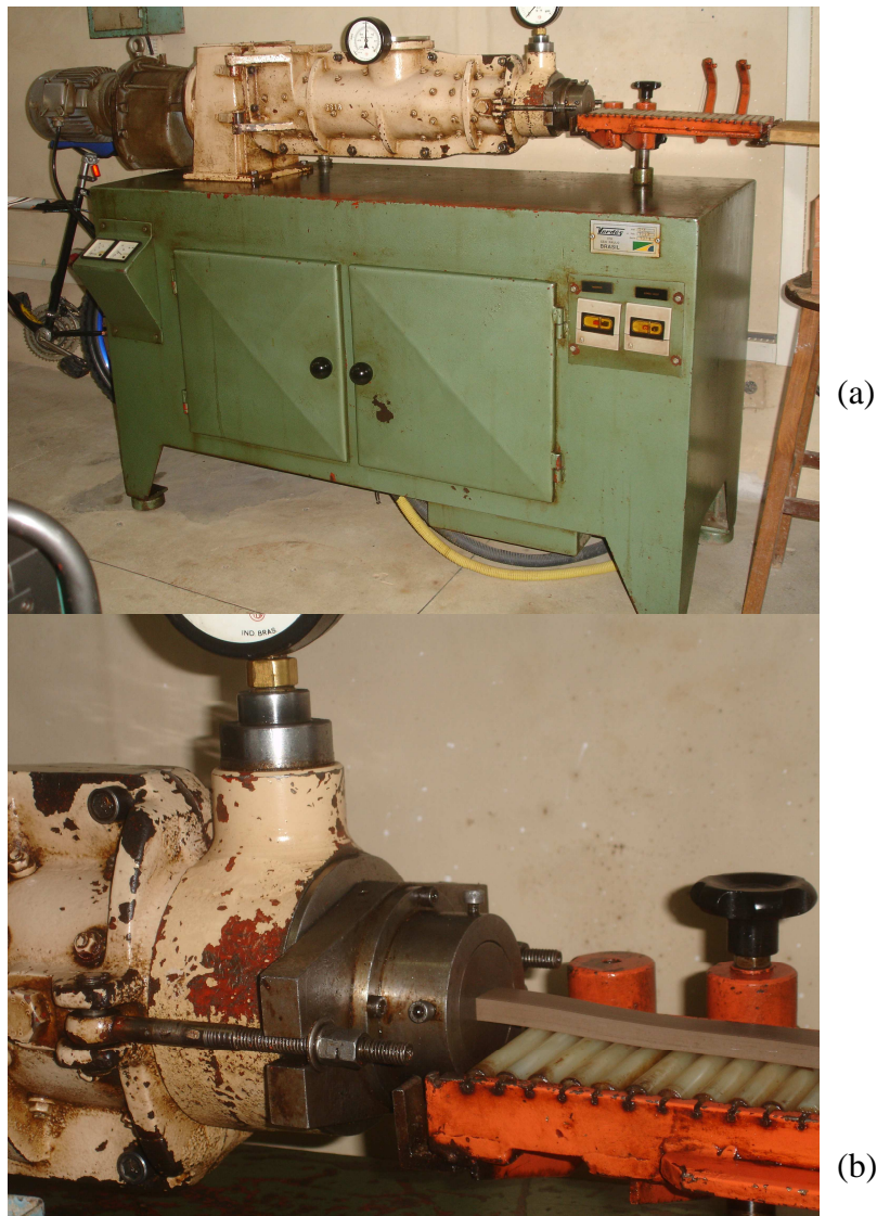
Figura 5.16 – Maromba de laboratório Modelo 51 da Marca VERDÉS. a) Vista geral. b) Vista com detalhe da extrusão
