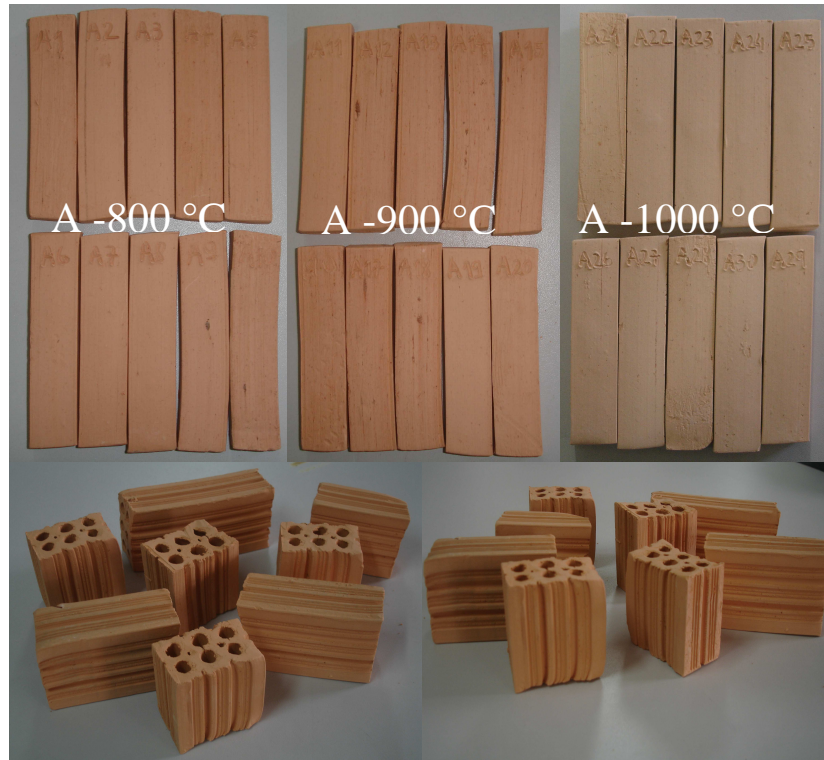
Figura 6.38 – Aspecto visual dos corpos-de-prova incorporados com resíduos e conformados pelo processo de extrusão
