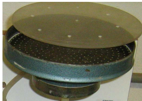
b) Funil e a tampa de acrílico perfurada, para evitar a evaporação de água.
