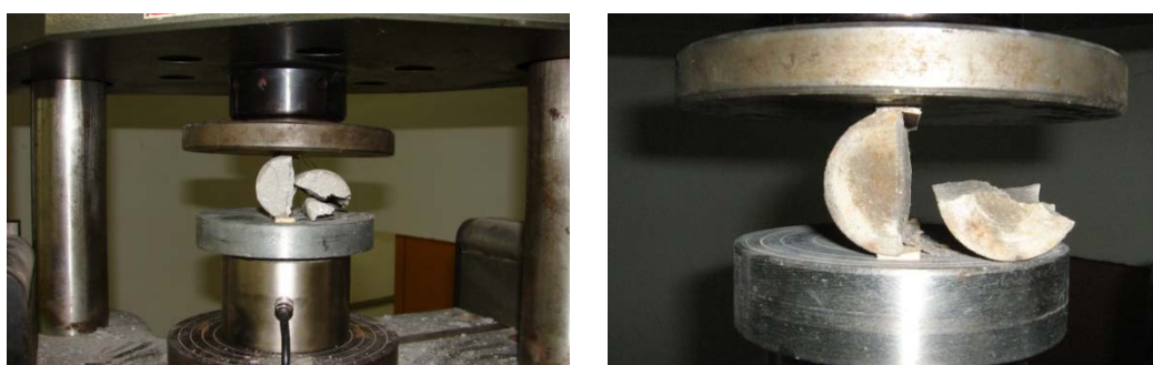
Figura 3.8 - Determinação da resistência à tração por compressão diametral segundo a NBR 7222/ 94.
