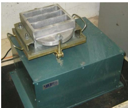
Figura 3.3 - a) Mesa vibratória para adensamento dos prismas; b) Molde utilizado para execução dos cps.
