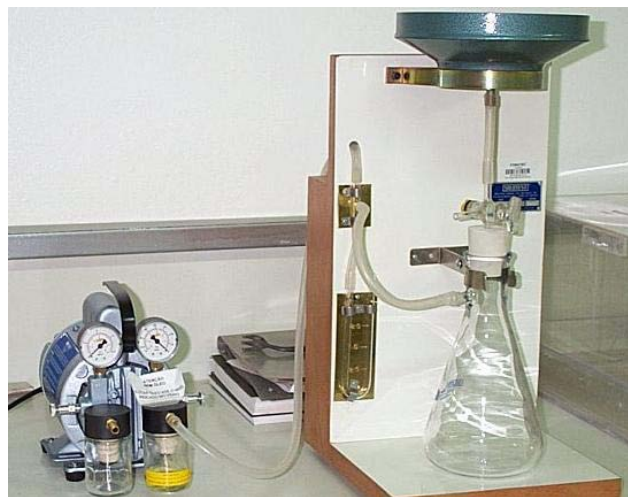
Figura 3.4- Equipamento utilizado no ensaio de retenção de água com o funil de Büchner modificado.
