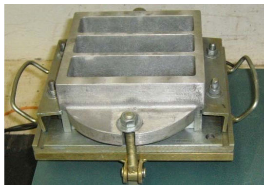
Figura 3.3 - a) Mesa vibratória para adensamento dos prismas; b) Molde utilizado para execução dos cps.
