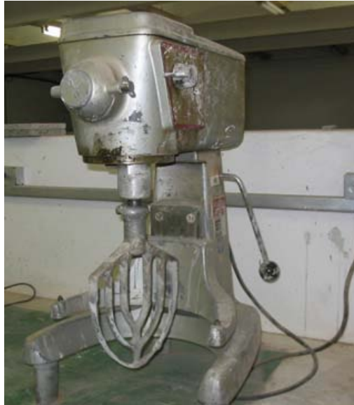
Figura 3.2- Misturador utilizado no preparo das argamassas.
