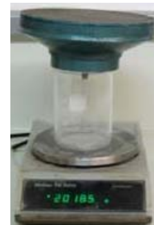
b) Registro da massa do funil com argamassa após a sucção
