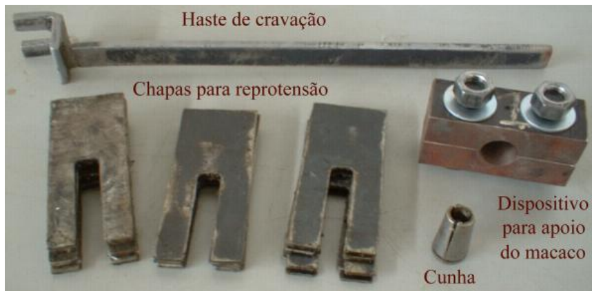
Figura 3.41 – Equipamentos empregados na protensão – VILLAVERDE (2008).
