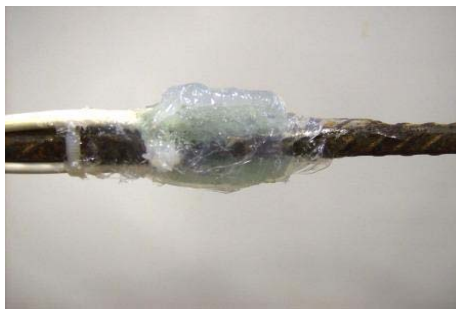
Figura 3.15 – Proteção mecânica dos extensômetros com silicone.
