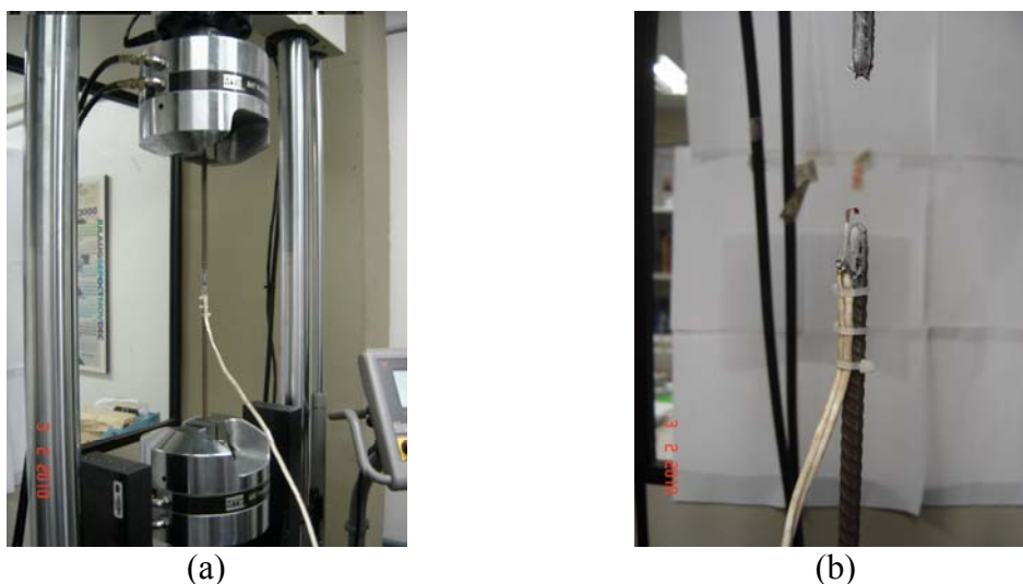
Figura 4.3 – Fotos da realização dos ensaios de caracterização do aço utilizado na confecção dos modelos de ligação laje-pilar de extremidade.
