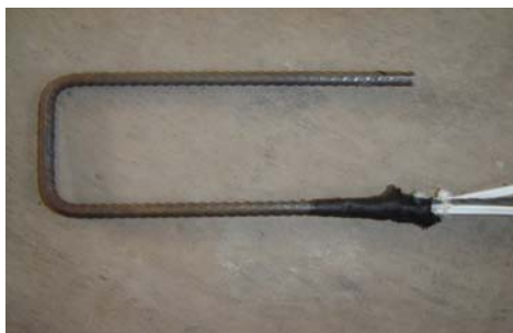
Figura 3.16 – Proteção final dos extensômetros com fita isolante.
