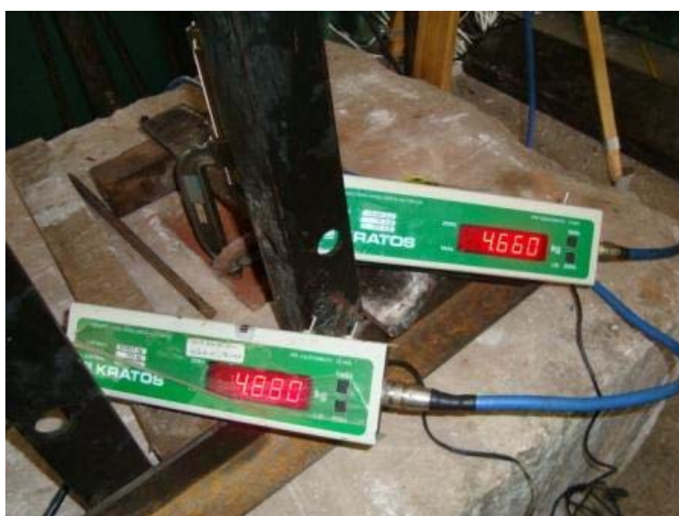
Figura 3.21 – Indicadores para acompanhamento dos passos de carga durante ensaio.
