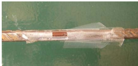
Figura 3.12 – Extensômetro colado em barra da armadura passiva.
