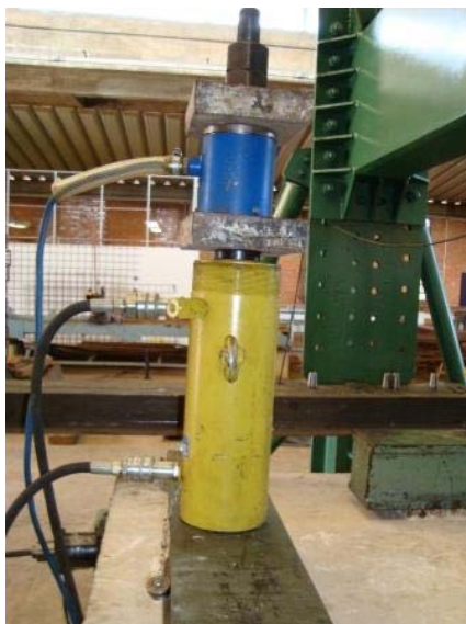
(a) – Macacos de aplicação das cargas P1.
