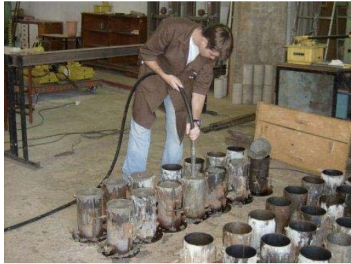
Figura 3.26 – Moldagem dos corpos de prova.
