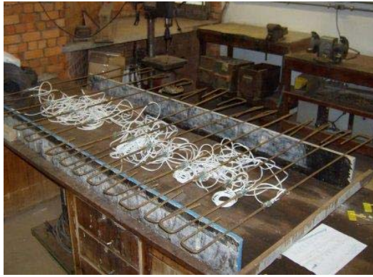
(a) – Bancada para instrumentação das barras.
