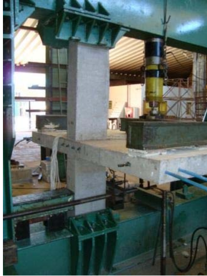
Figura 3.35 – Restrições metálicas nas extremidades do pilar.
