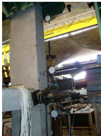
(g) – Defletômetros posicionados no pilar.
