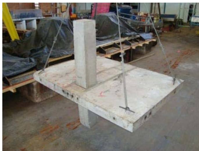
Figura 3.30 – Içamento e transporte dos modelos por meio de cabos de aço fixados em ganchos.
