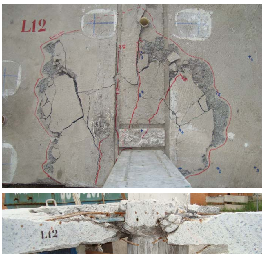
Figura 4.136 – Ruptura da laje do Modelo L12 – P1_D/P1_E = 4,0 ; P2 = 0,0 MPa.
