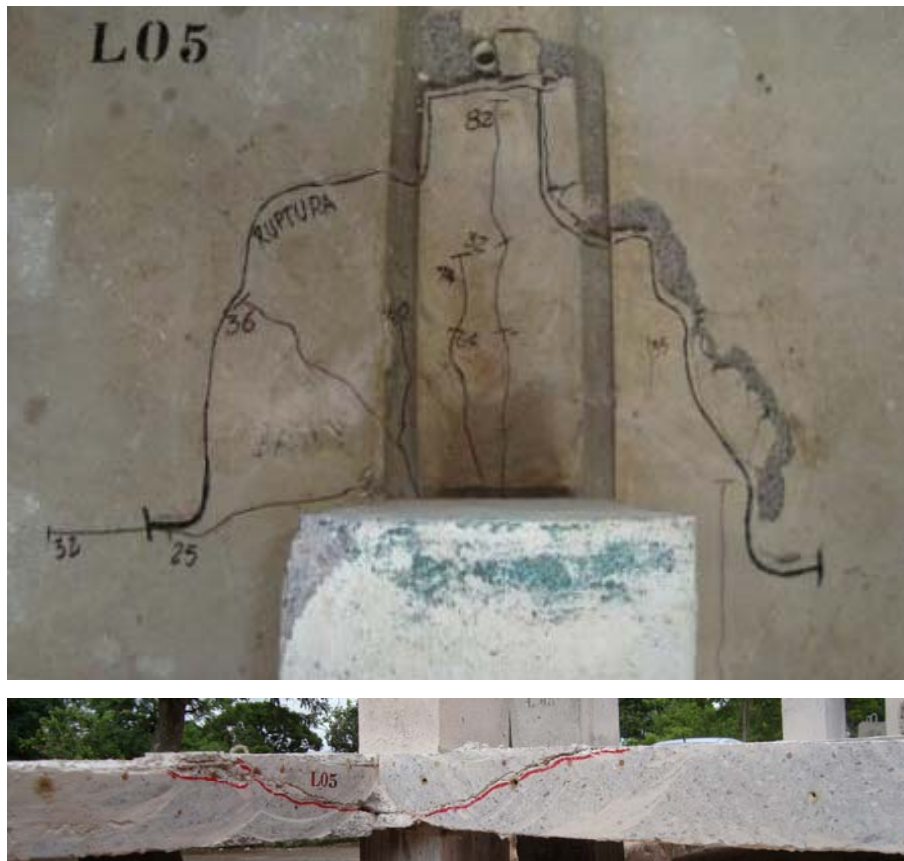
Figura 4.129 – Ruptura da laje do Modelo L05 – P1/P2 = 4,0 .
