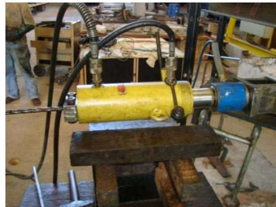
(b) – Sistema de protensão: barrilete, célula de carga, atuador hidráulico e dispositivo de fixação.
