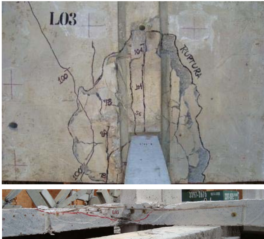
Figura 4.127 – Ruptura da laje do Modelo L03 – P1/P2 = 4,0 .
