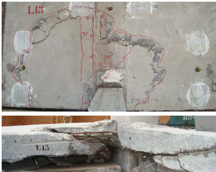
Figura 4.137 – Ruptura da laje do Modelo L13 – P_{1D}/P_{1E} = 4,0 ; P_2 = 0,0 MPa.
