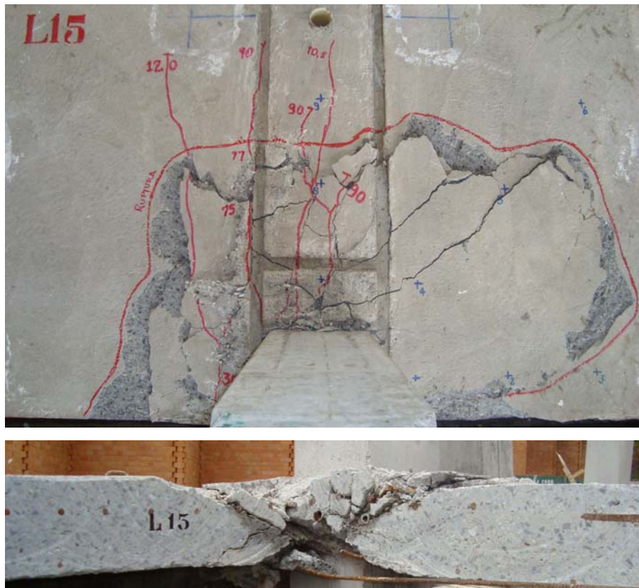
Figura 4.139 – Ruptura da laje do Modelo L15 – P_{1D}/P_{1E} = 2,0 ; P_2 = 0,0 MPa.
