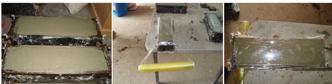
Figura 4.11 – Procedimentos de preparação dos corpos-de-prova com o envolvimento do conjunto com filme plástico, imediatamente após a moldagem.
