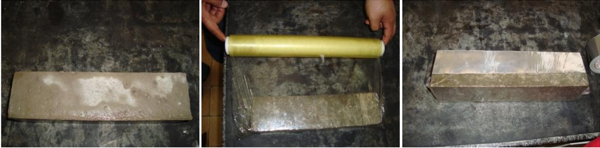
Figura 4.14 – Revestimento dos corpos-de-prova destinados às medidas de retração endógena.
