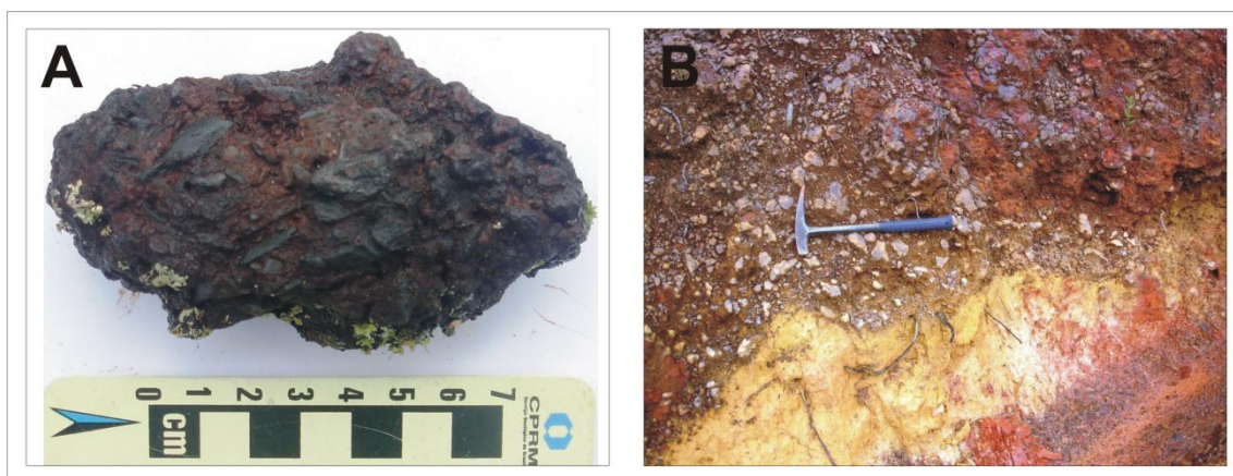
Figura 4.15 – (A) Bloco de canga formado sobre formação ferrífera, com fragmentos de hematita cimentados em uma matriz limonítica ; (B) Depósito coluvionares com fragmentos de hematita compacta;
