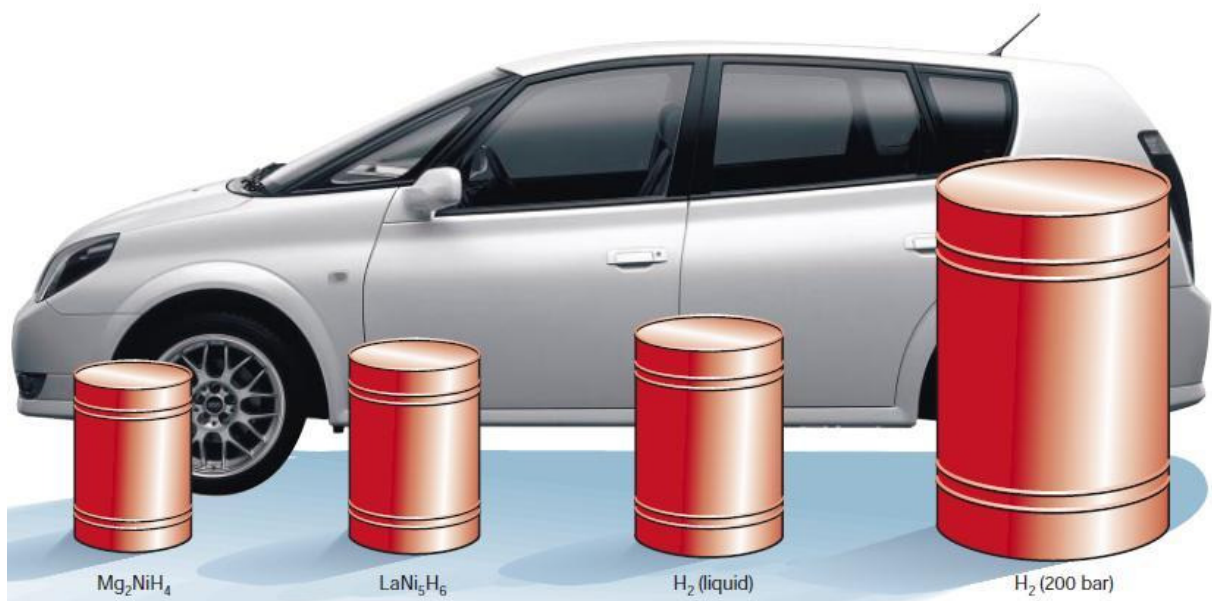
Figura 1: Esquemáticamente se representa o volume de 4 kg de hidrogênio compactado de modos diferentes, com tamanho relativo ao tamanho de um carro (Figura reproduzida da referência 1).
