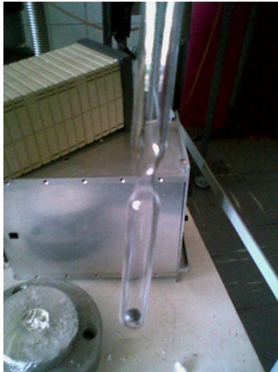
Figura 10: Amostra sendo selada em um tubo de sílica sob vácuo.
