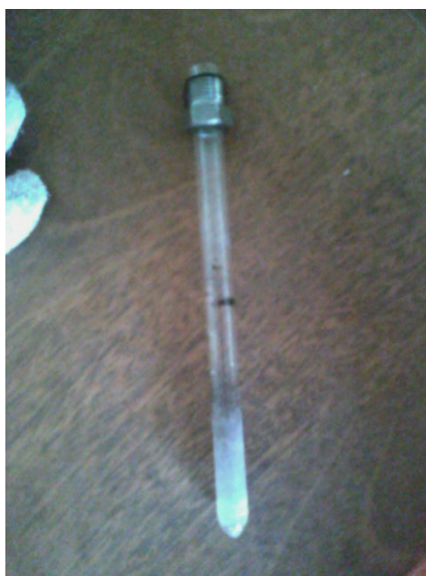
Figura 11: Ampola de quartzo usada no processo de hidrogenação do composto \text{GdNiIn} .
