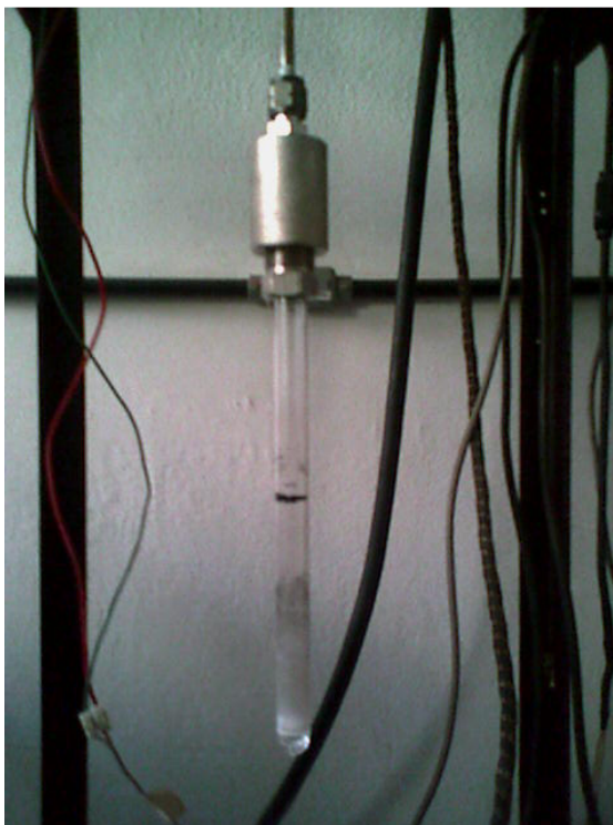
Figura 12: Ampola acoplada ao sistema de hidrogenação de amostras.
