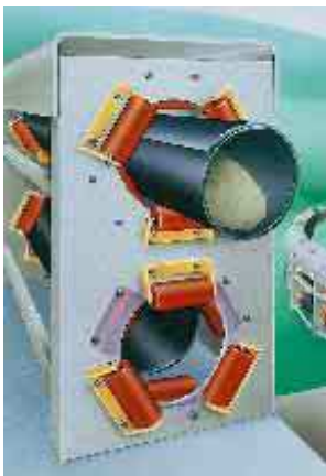
Figura 3.9 - Desenho esquemático e fotografia do Tube Belt Conveyor
