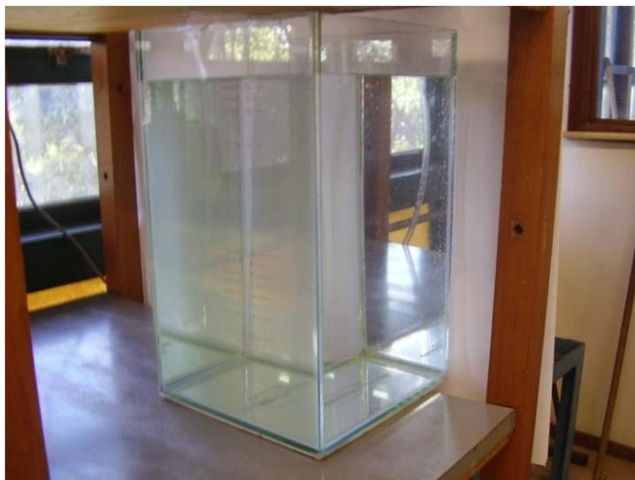
Figura 4.9 – Recipiente de vidro usado para mistura rápida e floculação, para produção de água para filtração em papel.
