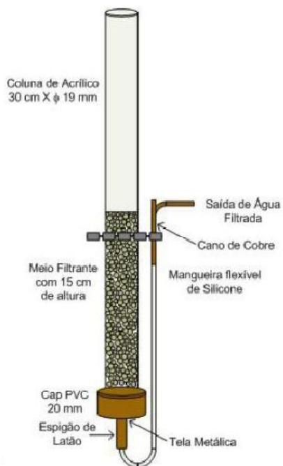
Figura 4.6 – Esquema do filtro de laboratório de areia utilizado nos testes de jarros (Fernandes, 2007).
