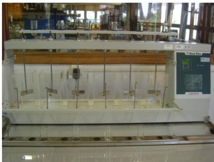
Figura 4.3 – Equipamento utilizado nos ensaios de testes de jarros.
