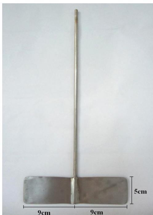
Figura 4.10 – Paletas em aço inoxidável usadas para mistura rápida e floculação, para produção de água nos experimentos de filtração em papel.
