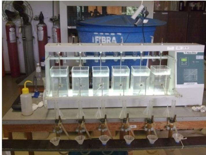
Figura 4.5 - Equipamento utilizado nos ensaios de testes de jarros com adaptação para filtração direta (Schleicher, 2011).
