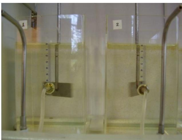
Figura 5.12 – Flocos amarelados formados pela adição do coagulante quitosana nas doses 1,0 mg/L (cubeta 1) e 1,5 mg/L (cubeta 2), em valor de pH de coagulação igual a 6,5.
