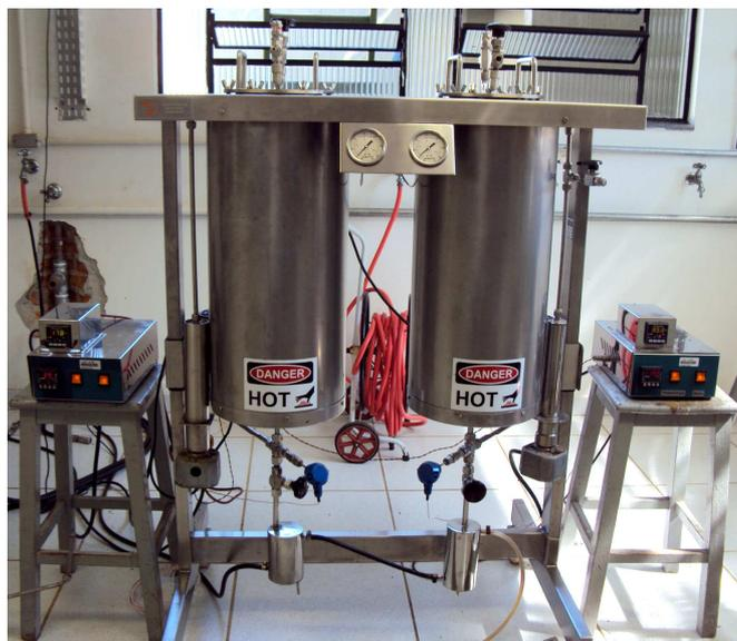
Figura 5 - Digestor M&K 610 utilizado no processo de polpação.
