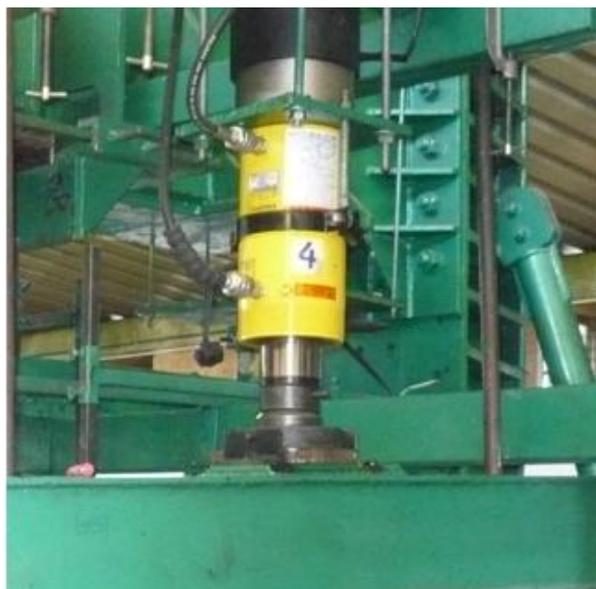
Figura 3.39 – Atuador hidráulico de aplicação de cargas.
