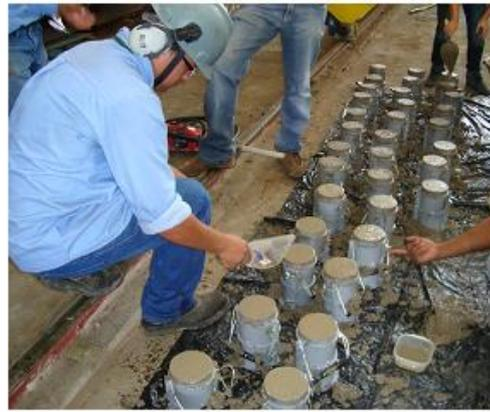
(b) Acabamento do corpo de prova.
