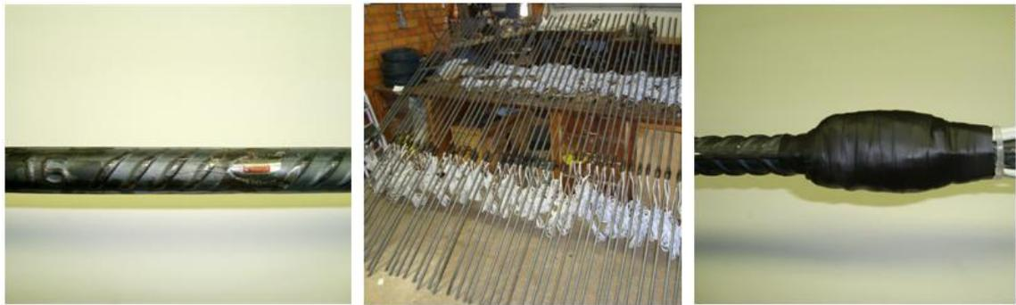
(a) Extensômetro colado em barra previamente preparada      (b) Disposição das barra após o preparo      (c) Proteção final da instrumentação
