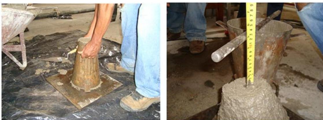
Figura 3.20 – Teste de abatimento do tronco de cone.
