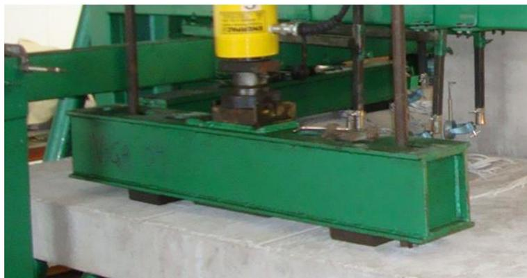
Figura 3.44 – Viga de distribuição da carga.
