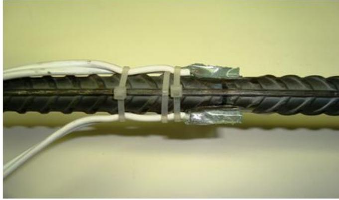
Figura 3.23 – Posição dos extensômetros da armadura de flexão.
