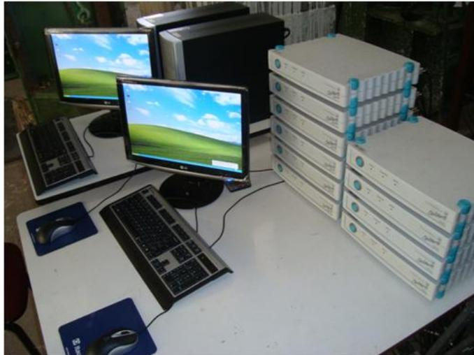
Figura 3.35 – Sistema de aquisição de dados.
