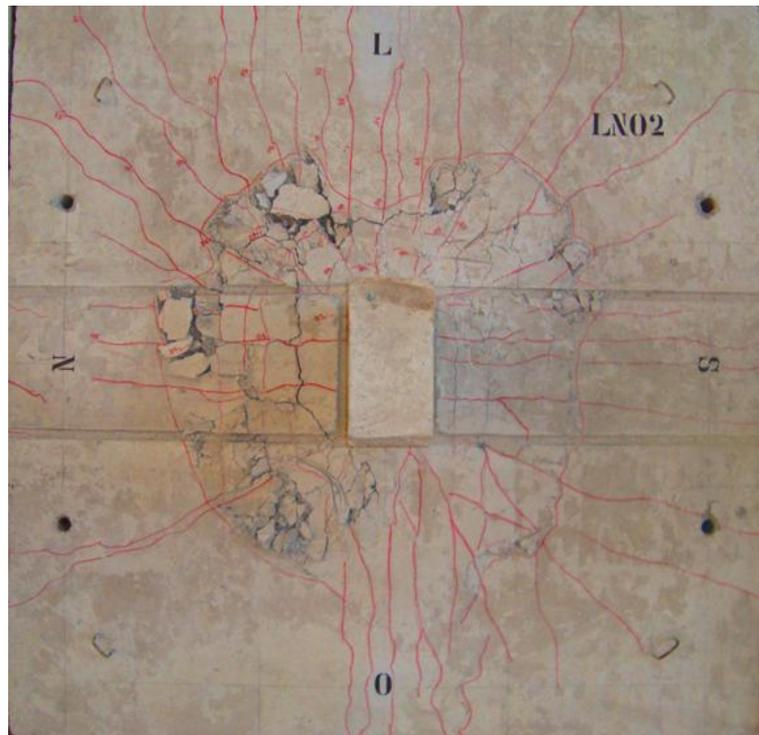
Figura 4.74 – Padrão de fissuração do modelo LN02.
