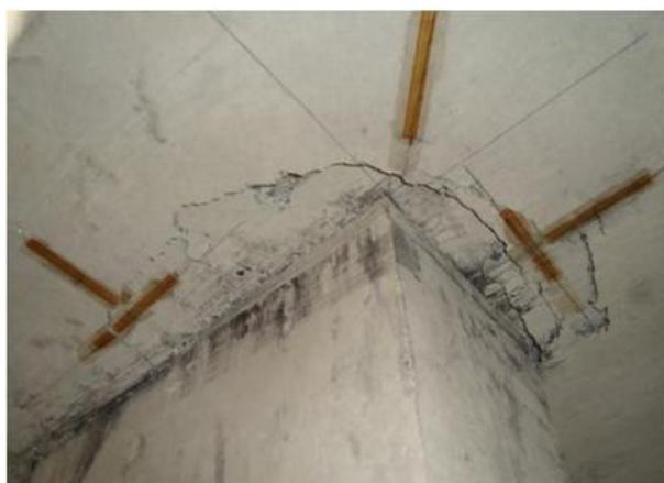
Figura 3.32 – Disposição dos extensômetros em um dos modelos.
