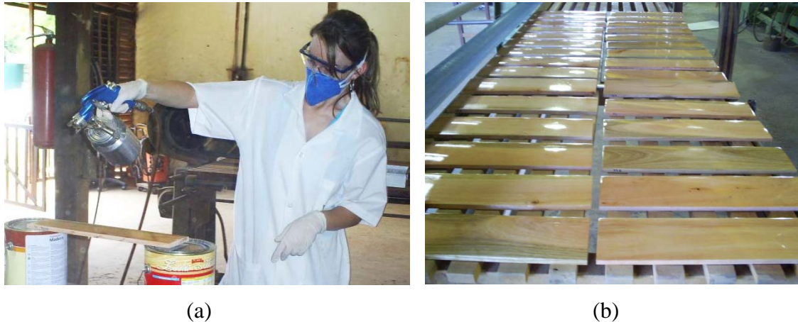
Figura 4.2 – Aplicação dos produtos de acabamento (a) e secagem final das peças (b).
