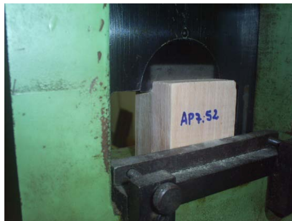
Figura 4.6 – Ensaio de cisalhamento das peças coladas
