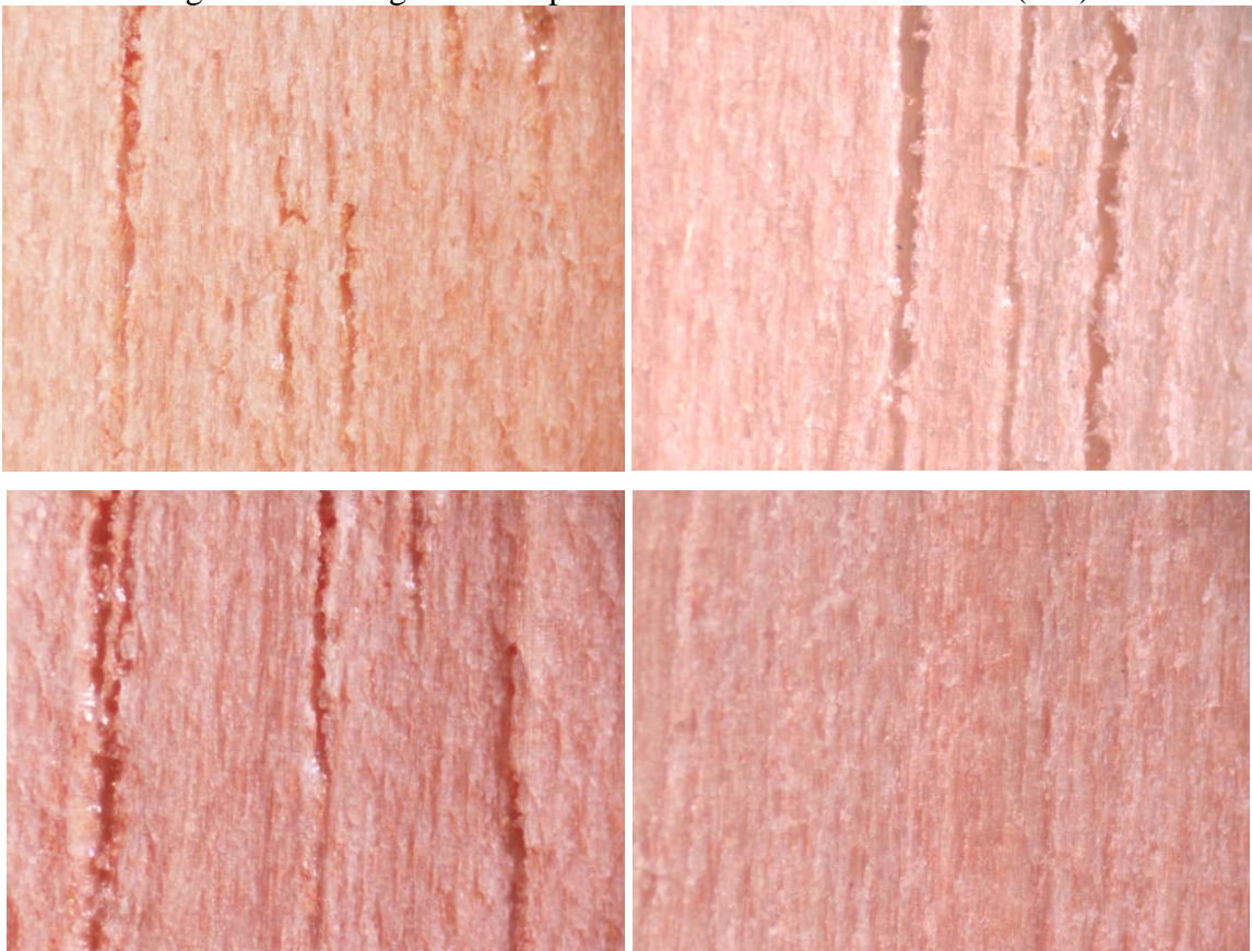
Figura 5.3 – Imagens das superfícies aplainadas de E. benthamii (50x).
