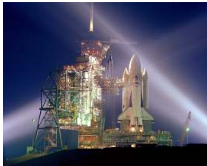
Figura 2.18 – Ônibus espacial Columbia. Os três cilindros sobre os quais o ônibus está afixo constituem o sistema de propulsão suficiente apenas para o lançamento do veículo espacial. Para fins de comparação, remetemo-nos à figura 2.9, da sonda Deep Space 1 , que funcionou ininterruptamente durante meses e cujo sistema de propulsão representa percentual em massa bastante menor que o aqui mostrado. Reproduzido de http://www.nasa.gov/ .
