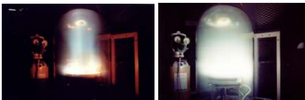
Figura 4.4 – Propulsor PHALL em funcionamento. À esquerda, em regime de baixa corrente de descarga; à direita, regime de alta corrente.
