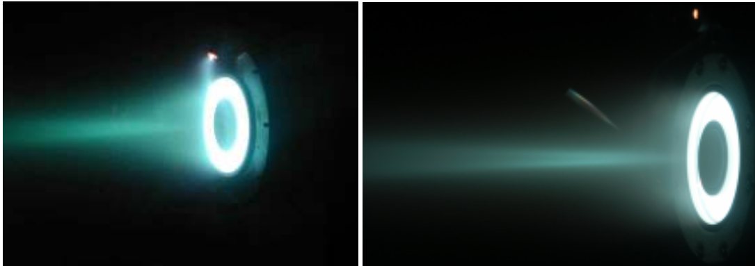
Figura 2.14 – Sistema de propulsão do tipo SPT. Elétrons emitidos pelo catodo (na parte superior das fotos) são drenados para dentro do canal de aceleração, originando uma corrente Hall . Um gás injetado nesse canal sofre ionização por impacto eletrônico, momento em que é produzido o plasma, e este é acelerado pelos campos eletromagnéticos presentes no propulsor. Reproduzidas de http://htx.pppl.gov/ .
