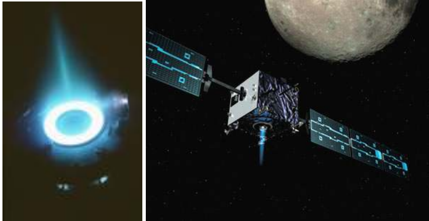
Figura 2.4 – À esquerda, o sistema de propulsão utilizado na sonda SMART-1. À direita, visão artística da sonda SMART-1. Reproduzidas de http://sci.esa.int/ .
