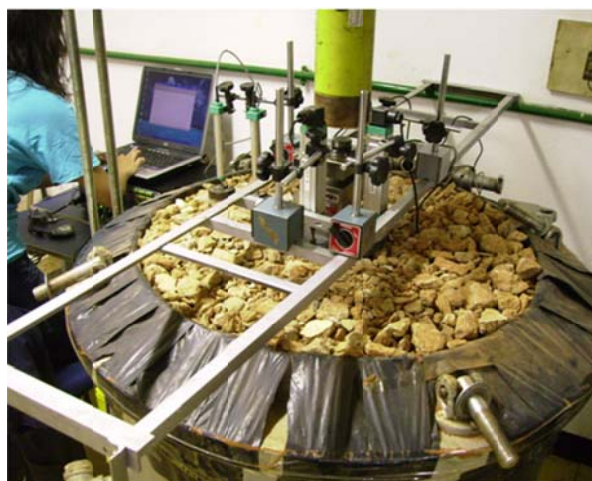
Figura 3.23 Disposição dos medidores de deslocamento linear no ensaio.
