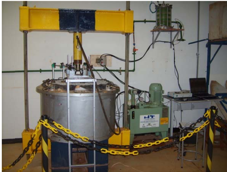
Montagem do ensaio realizado com brita
