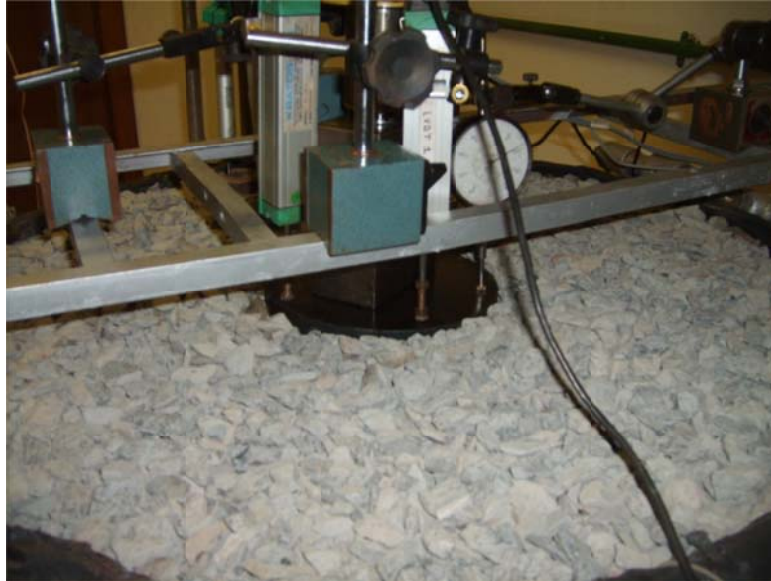
Detalhe do afundamento da placa
