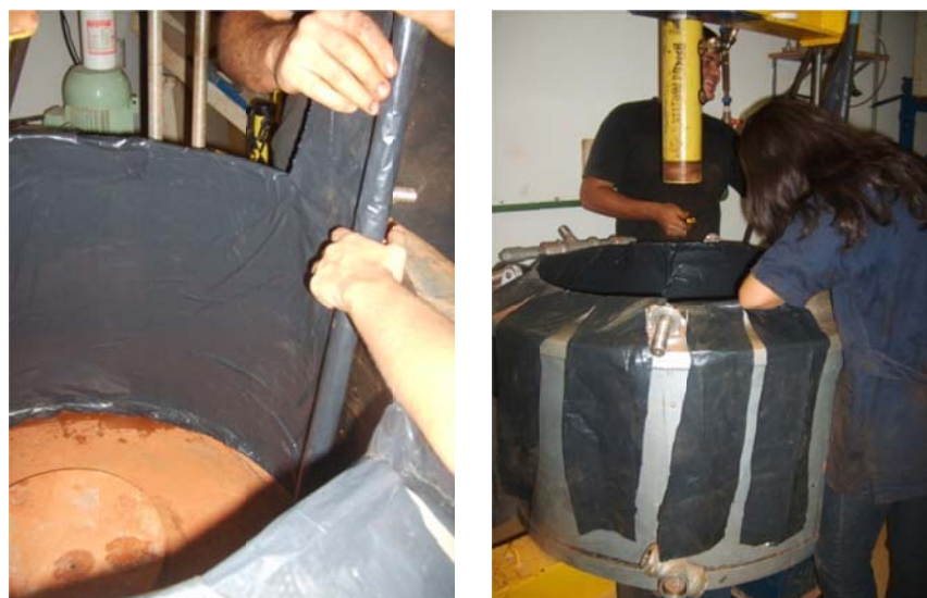
Figura 3.15 Colocação da lona para evitar atrito lateral.
