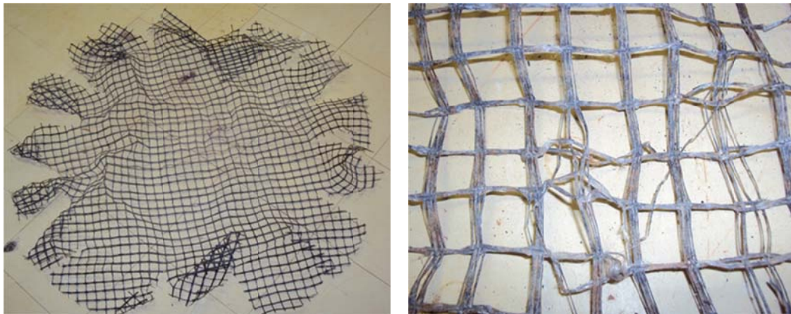
Figura 4.30 Estado da Geogrelha 2 após do terceiro estágio de carga.
