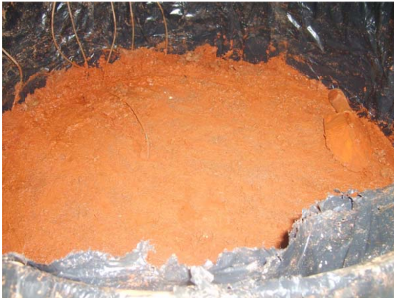
Retiro do material de aterro após a simulação de chuva.
