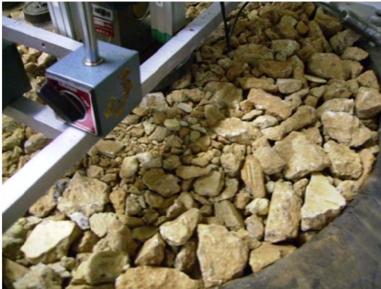
Detalhe do RCD-R colocado como aterro
