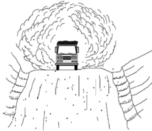
Figura 2.2 Excesso de pó na pista (SANTOS et al., 1985).
