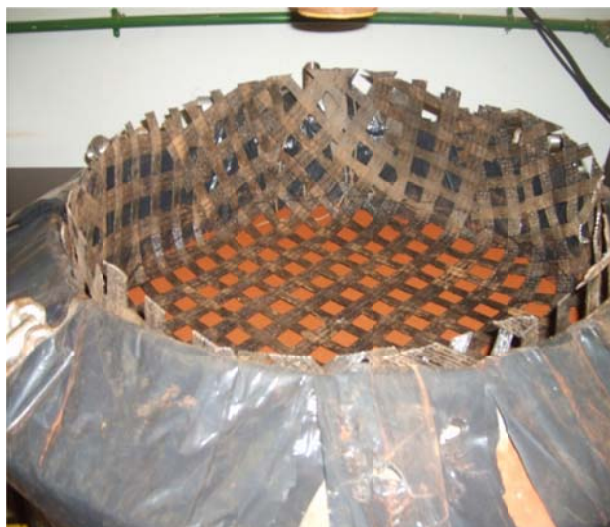
Figura 3.21 Colocação do reforço no ensaio 2.
