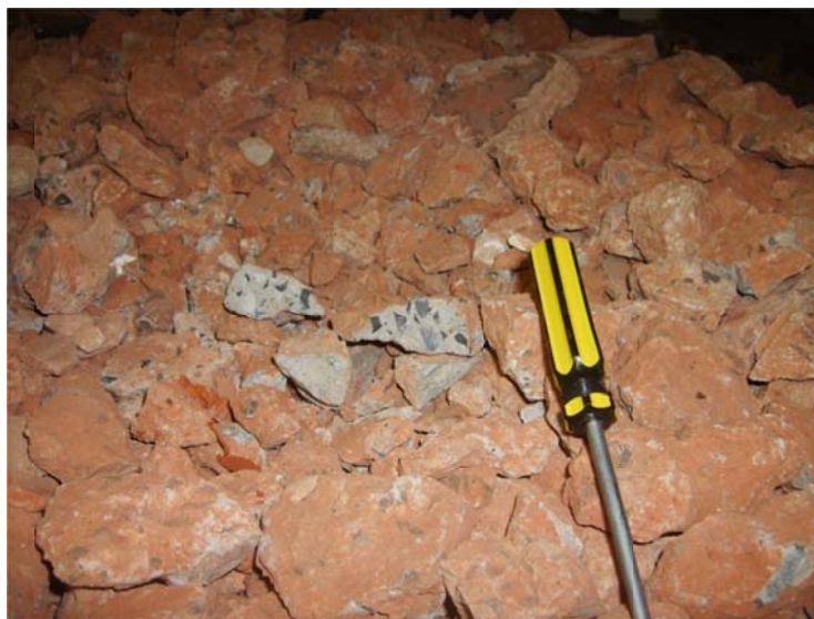
Figura 3.8 Resíduo de construção e demolição reciclado utilizado na pesquisa.
