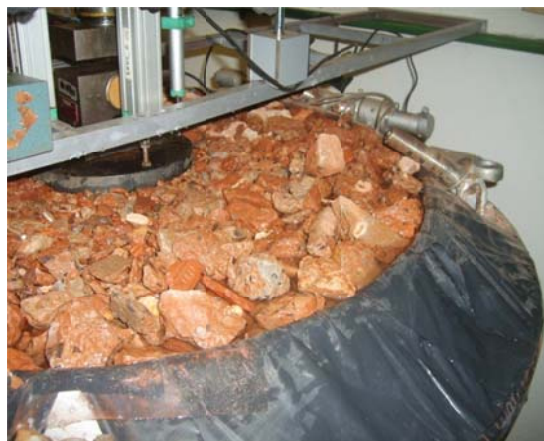
Figura 3.19 Simulação do umedecimento no aterro
