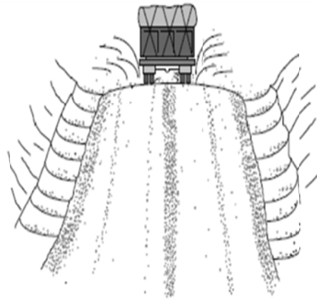
Figura 2.3 Segregação de agregados (SANTOS et al., 1985).
