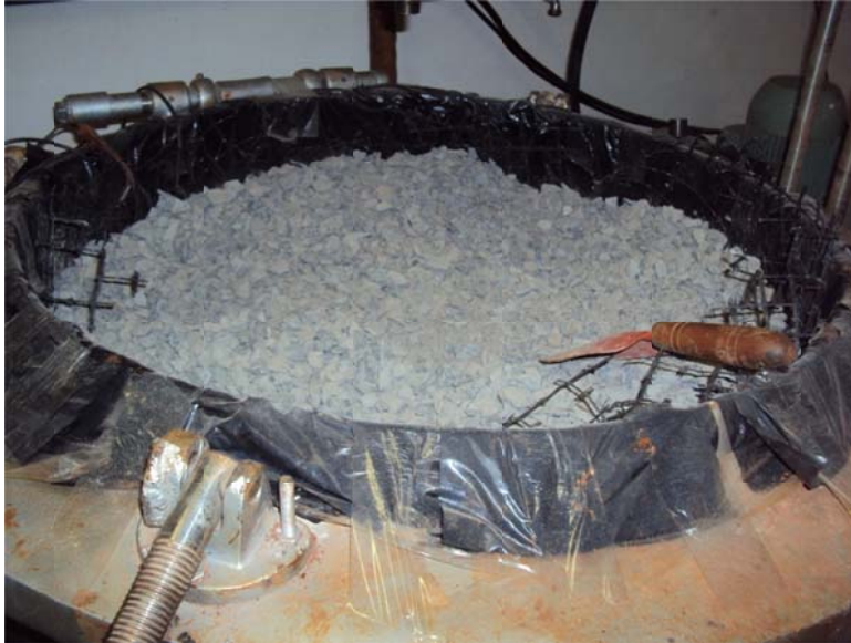
Disposição do material de aterro no ensaio
