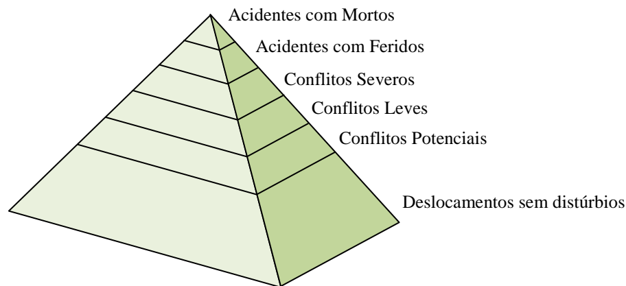
Figura 4.1: Pirâmide da segurança - Interação rodovia - usuários em eventos contínuos (Hydén, 1987, apud Hernández, 2002)
