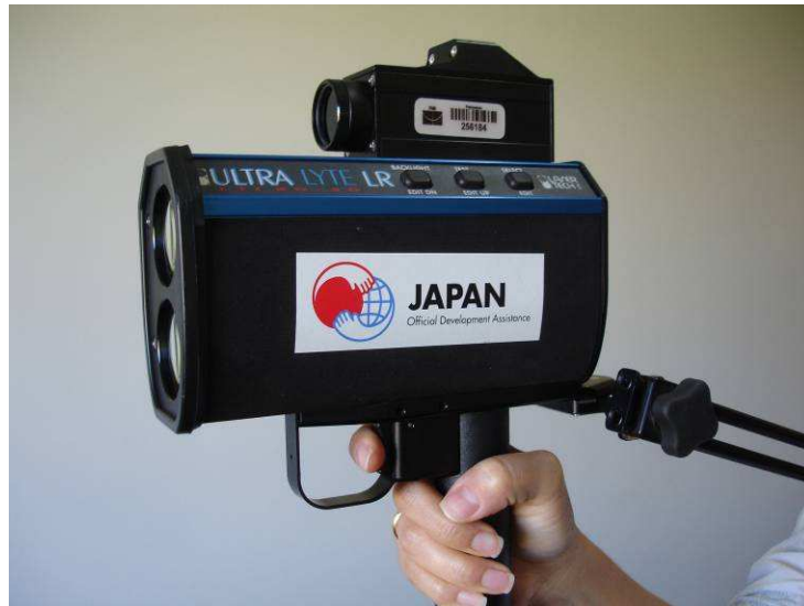
Figura 5.9: Medidor de velocidade portátil - ULTRA LYTE LR (LTI 20-20)
