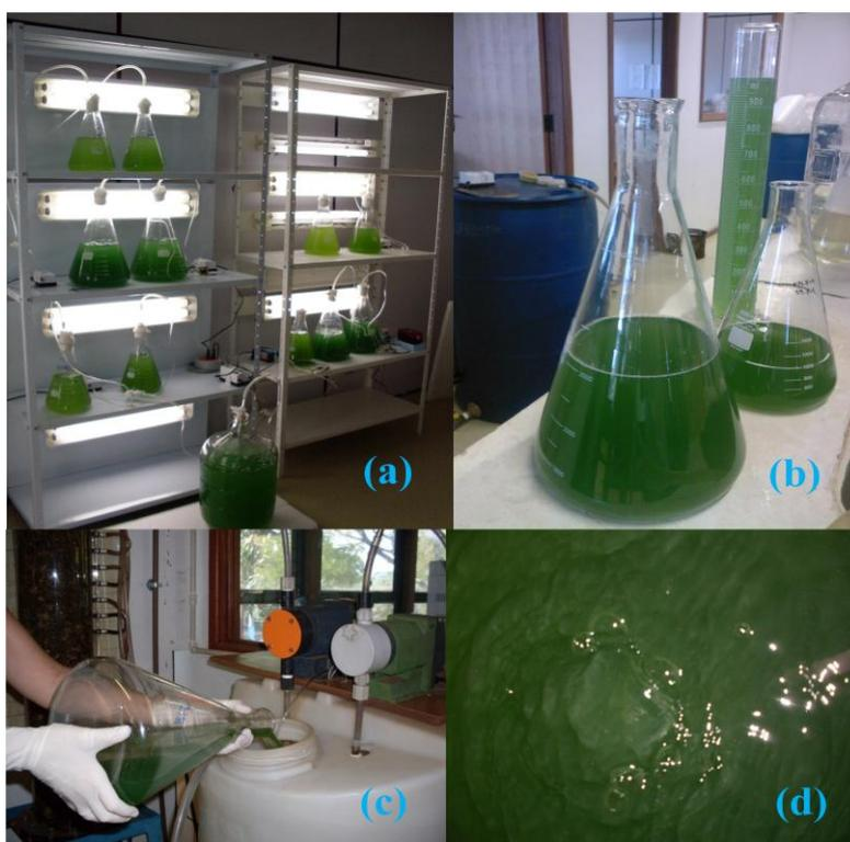
Figura 4.5 – (a) Sala de cultivo, (b) cultivo de *M. aeruginosa* com cerca de 15 dias de crescimento, (c) Adição de cultivo a água bruta do lago Paranoá e (d) aspecto da água com concentrações de  $10^6$  cél./mL no reservatório de água bruta.
