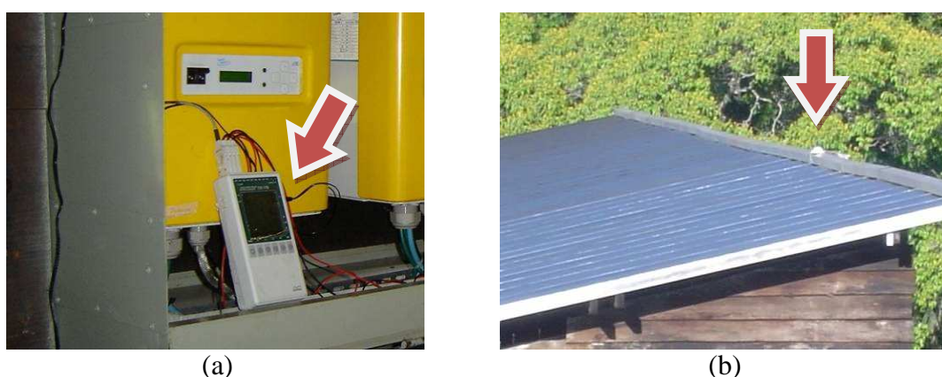
Figura 4.12 (a) DataLogger ALMEMO 2590-9; (b) Piranômetro instalado no telhado dos módulos FVs do SHGD CPC.
