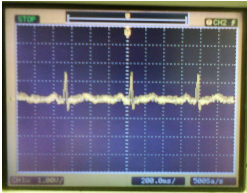
Figura 3.27: Sinal de ECG (D2) capturado com o circuito em protoboard
