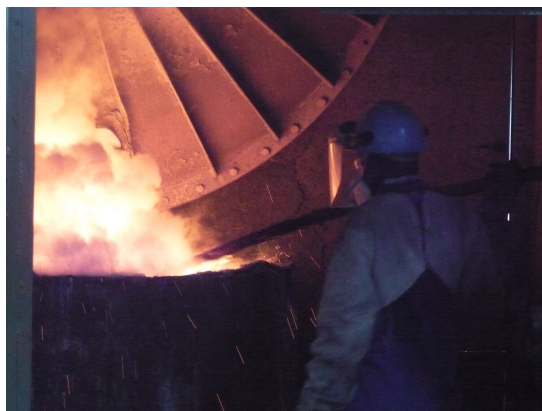
Figura. 3.4: Processo de drenagem do chumbo após sua redução.
