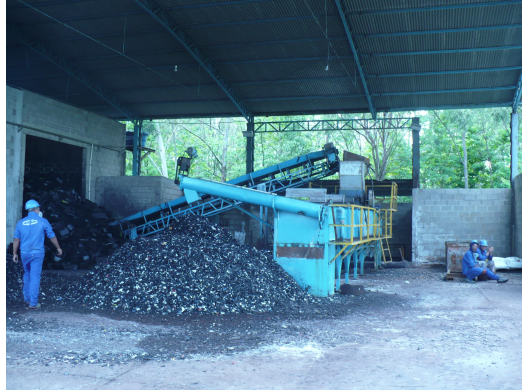
Figura. 3.2: Máquina responsável pela trituração das partes plásticas da bateria.
