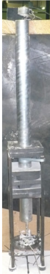
Figura 5.1: Bancada de teste (Tubo de Teste de Explosividade - BTE).
