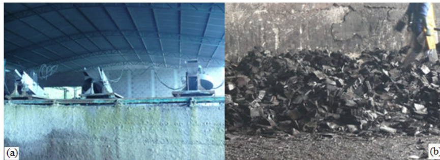
Figura. 3.1: (a) serras para o corte das baterias, (b) a parte metálica da bateria
