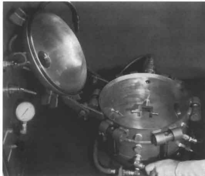
Figura 3.10: Foto de uma bomba de 20 litros para teste de explosão, (Adaptado de Eckhoff, 2003).
