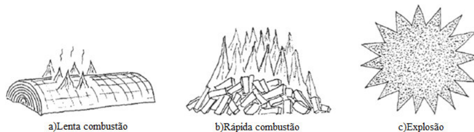
Figura 3.6: Ilustração do aumento da velocidade de combustão de uma dada massa de um combustível sólido aumenta com o acréscimo de sua subdivisão, (Adaptada de Eckhoff, 2003).
