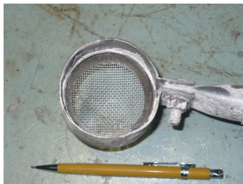
Figura 5.2: Peneira com diâmetro interno de 6,5cm, malha da tela de aço 18x16 e diâmetro 0,28 milímetros.
