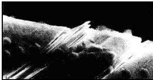
Figura 3.7 – Extrusões e intrusões em uma chapa de cobre (41) .
