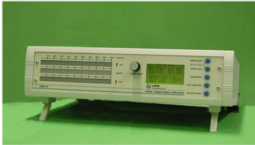
Figura 2.63: Amplificador de dois canais biomecânicos MISO II. Fonte: Manual do equipamento.
