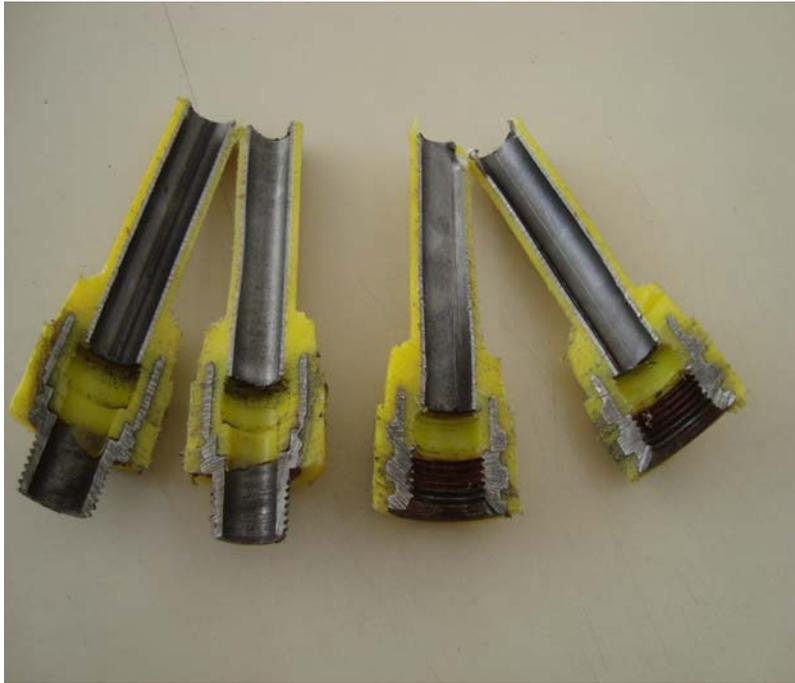
Fig. 3.3 Corte longitudinal do tubo e luva após a termofusão
