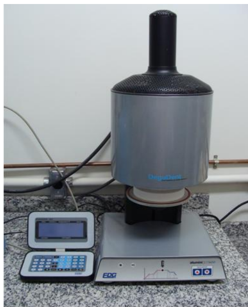
Figura 5: Forno Alumini Press para simular a aplicação da porcelana
