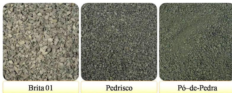
Figura 3.16. Frações do agregado calcário utilizado na pesquisa
