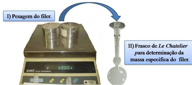
Figura 3.20. Esquema do ensaio para determinação da peso específico do filer.
