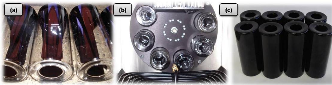
Figura 3.13. Amostras e procedimentos realizados no ensaio de envelhecimento. (a) Frascos com amostras antes do envelhecimento, (b) amostras na prateleira da estufa e (c) amostras após o ensaio.
