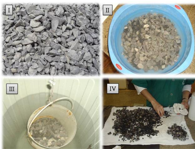
Figura 3.18. Esquema de alguns procedimentos feitos para determinação da densidade aparente do agregado graúdo
