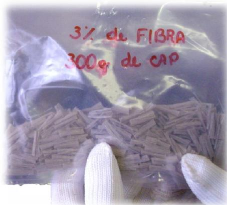
Figura 3.2. Amostras de fibra de polipropileno para o teor de 3,0%
