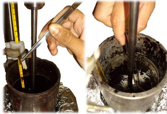
Figura 3.4. Procedimento de adição das fibras e mistura
