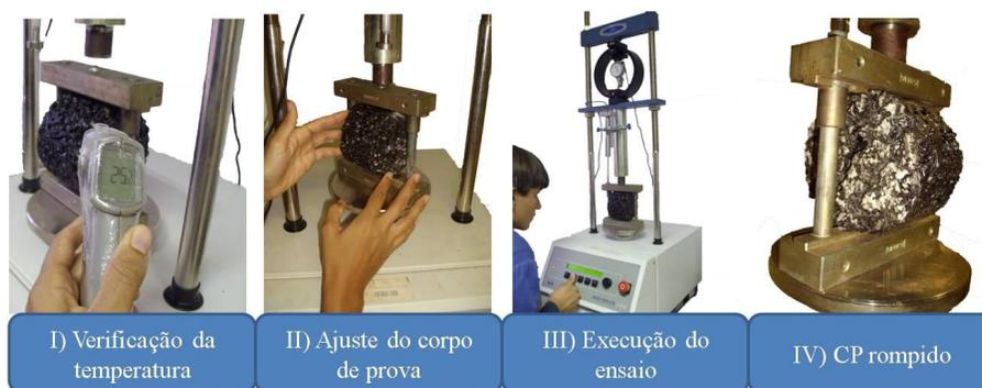
Figura 3.32. Procedimentos e prensa mecânica utilizada para realização dos ensaios de resistência à tração; LER-Ceftru-UnB.
