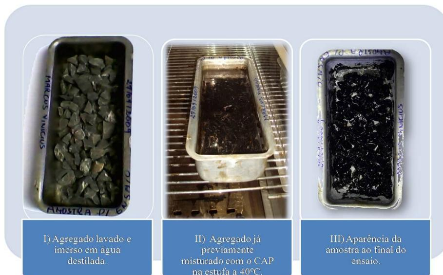
Figura 3.23. Esquema do ensaio de adesividade
