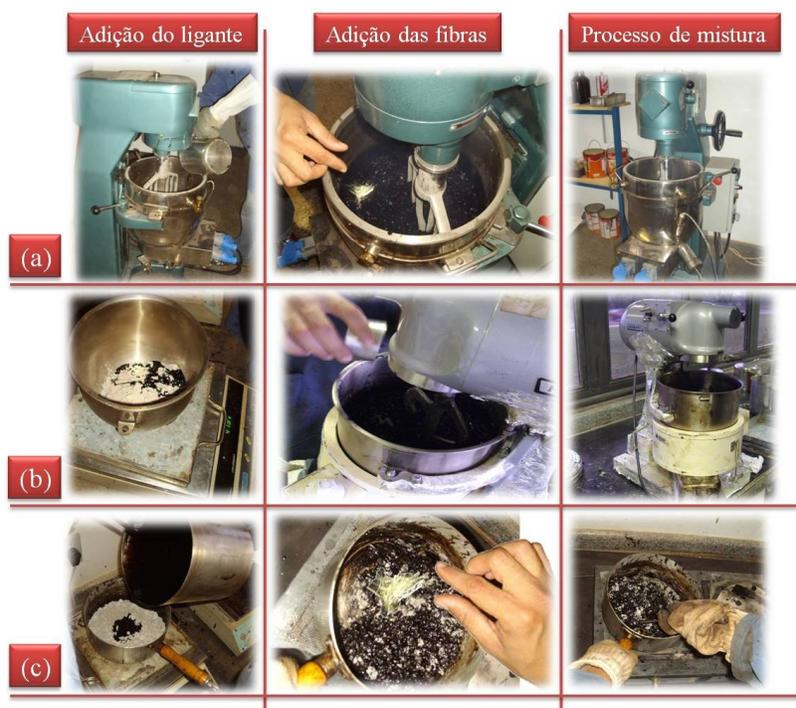
Figura 3.27. Procedimentos de mistura mecânicos (a) e (b) e manual (c).
