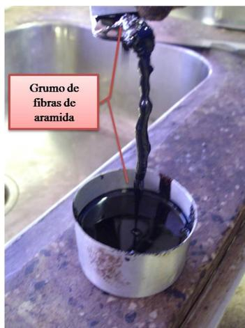
Figura 3.26. Formação de grumos de fibras de aramida quando adicionadas ao CAP
