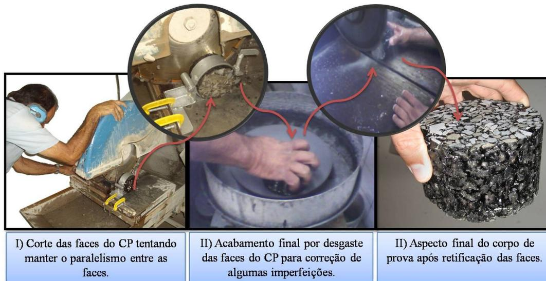
Figura 3.34. Retificação das faces dos corpos-de-prova para um melhor paralelismo entre as faces.
