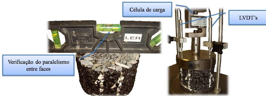
Figura 3.35. Esquema de montagem do CP para o ensaio de fluência estática
