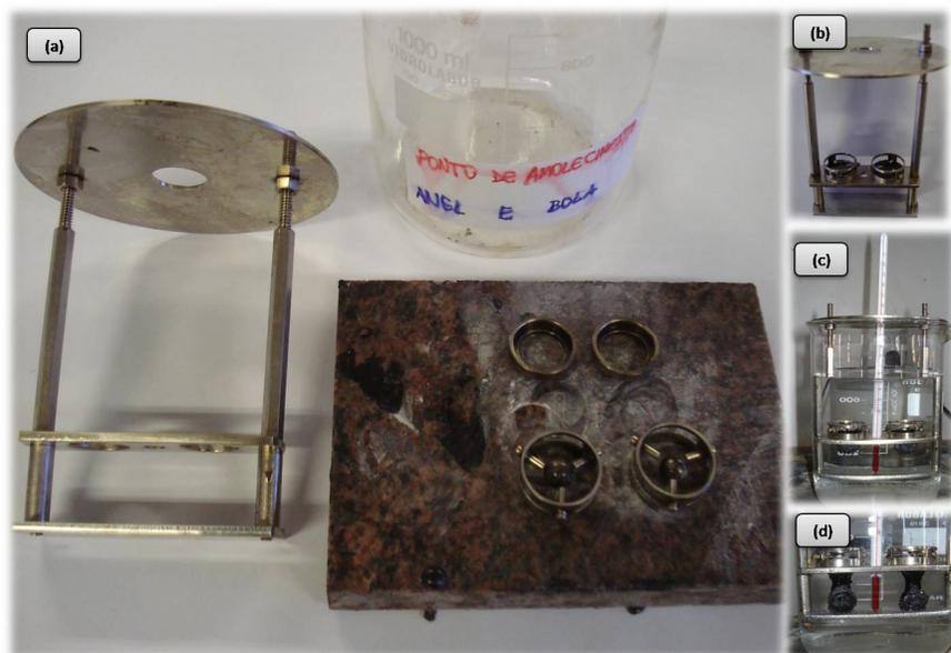
Figura 3.6. Equipamento utilizado no ensaio ponto de amolecimento (a), colocação da amostra no aparato de ensaio (b), execução do ensaio (c) e detalhe do término do ensaio (d)
