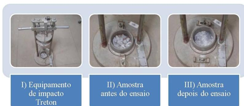
Figura 3.22. Esquema do ensaio sobre resistência ao impacto Treton
