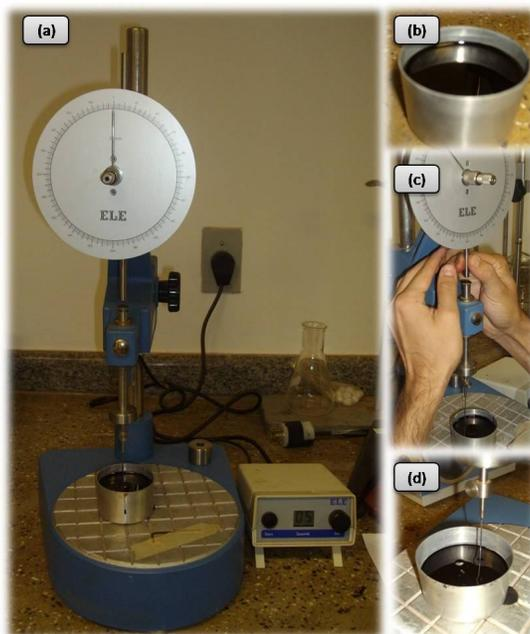
Figura 3.5. Equipamento utilizado no ensaio de penetração (a), amostra de CAP -50g (b), execução do ensaio (c) e detalhe da penetração na amostra (d)
