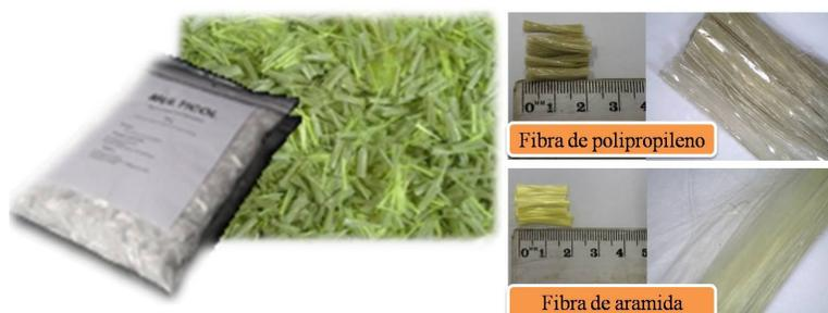
Figura 3.1. Detalhe das fibras usadas para adição nas misturas asfálticas: aramida (amarela) e polipropileno (cinza).
