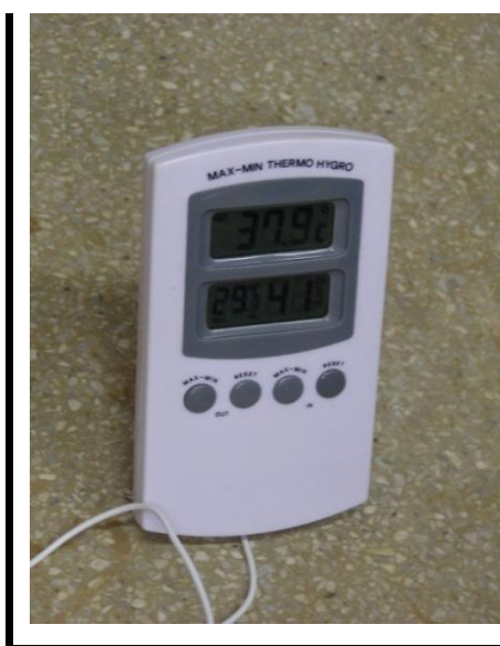
FIGURA 2.2– Termo-higrômetro digital máxima e mínima com sensor, marca INCOTERM
