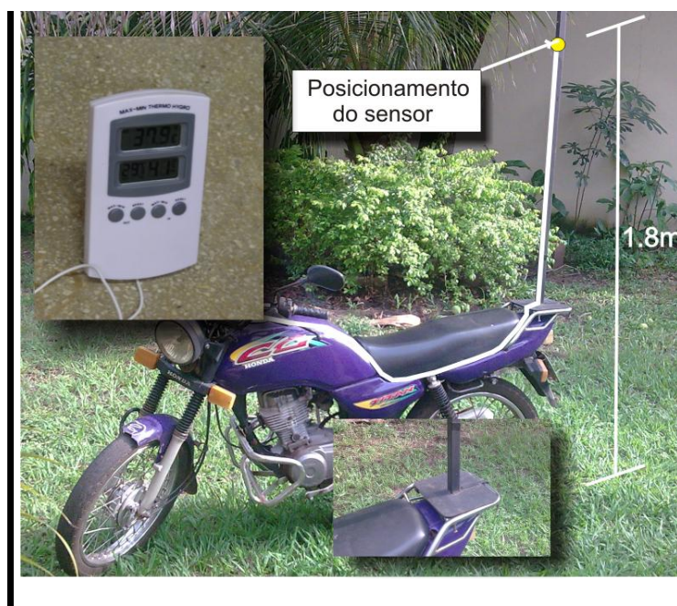
FIGURA 2.11 – Termo-higrômetro digital máxima e mínima com sensor, Marca Incoterm, e Esquema de instalação do equipamento sobre a moto
