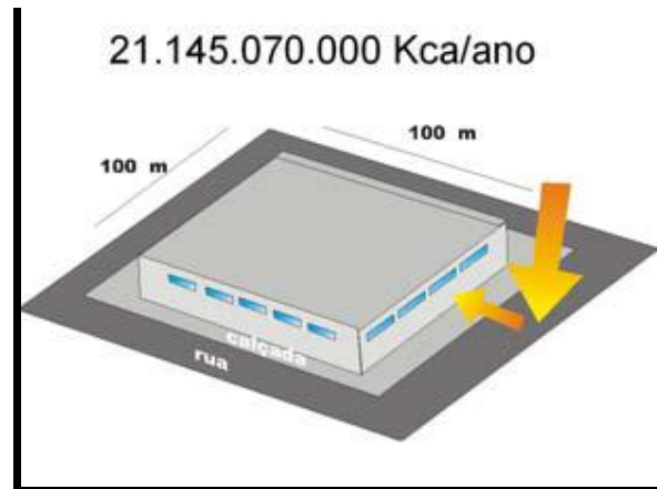
FIGURA 1.15: Quantidade de calor absorvido por uma quadra sem vegetação. Desenho muito semelhante ao que ocorre na maioria das quadras em Palmas-TO.
