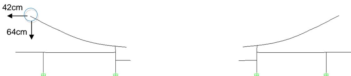
Figura 154: Diagrama de Deslocamento Elástico (esc. 5x). Desenho do autor. Programa SAP 2000.
