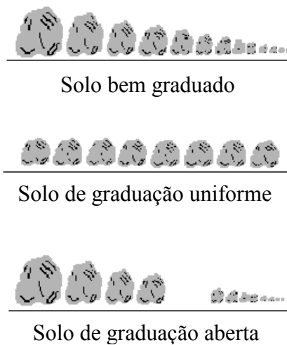
Figura 2.1. Representação esquemática da granulometria dos solos. Adaptado de CAPUTO, 1975.
