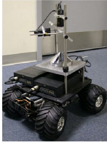
Figura 2.10 – Sistema de visão omnidirecional composto pela associação de duas câmeras com um espelho cônico embarcado em um robô móvel (Lin e Bajcsy, 2003).
