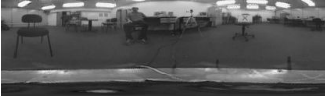
Figura 2.13 - Imagem adquirida com o espelho esférico retificada pelo método de transformação direta de coordenadas (Grassi-Jr et al, 2001).
