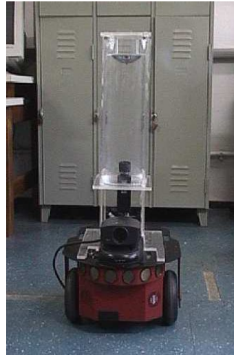
Figura 2.6 - Robô Pioneer2-DX com sistema de visão embarcado (Vassallo, 2004).
