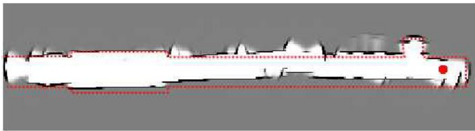
Figura 2.28 - Mapa construído com a correção dos erros sistemáticos de odometria (Santana Souza, 2008).
