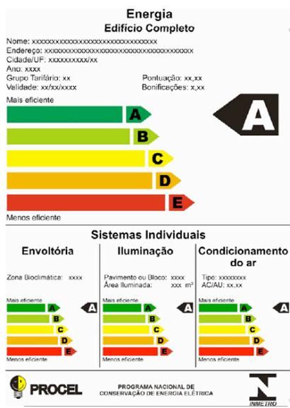
**Figura 28:** Modelo da Etiqueta nacional de Conservação de Energia – ENCE, neste caso, apresentando níveis de eficiência A. Fonte: RTQ-C (2009).
