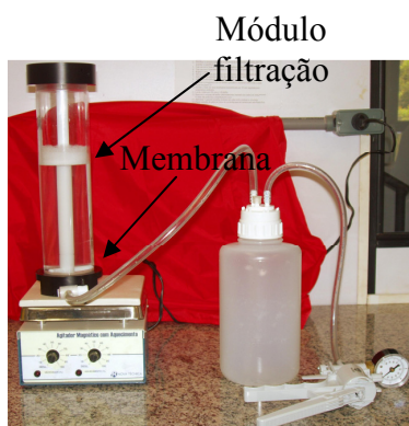
Figura E.5: Filtração a vácuo em membrana utilizando bomba a vácuo manual.
