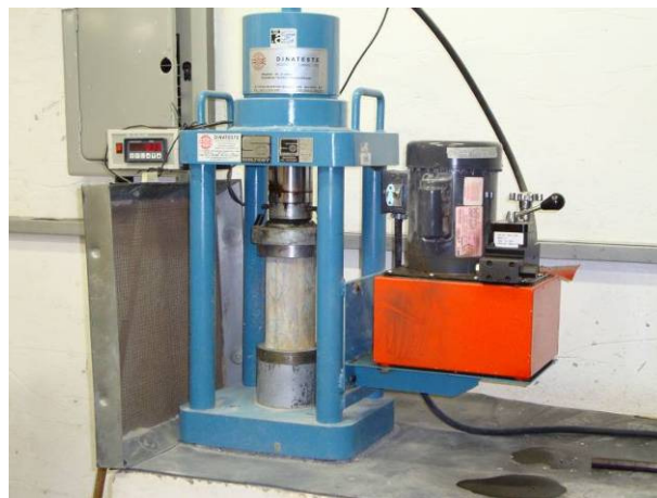
Figura 3-19 – Ensaio de resistência à compressão
