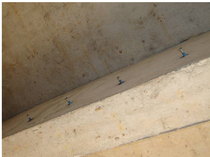
Figura 3-6 Estudo piloto de potência para a obra B ( f_{cj} = 34,7 MPa) – Potência baixa
