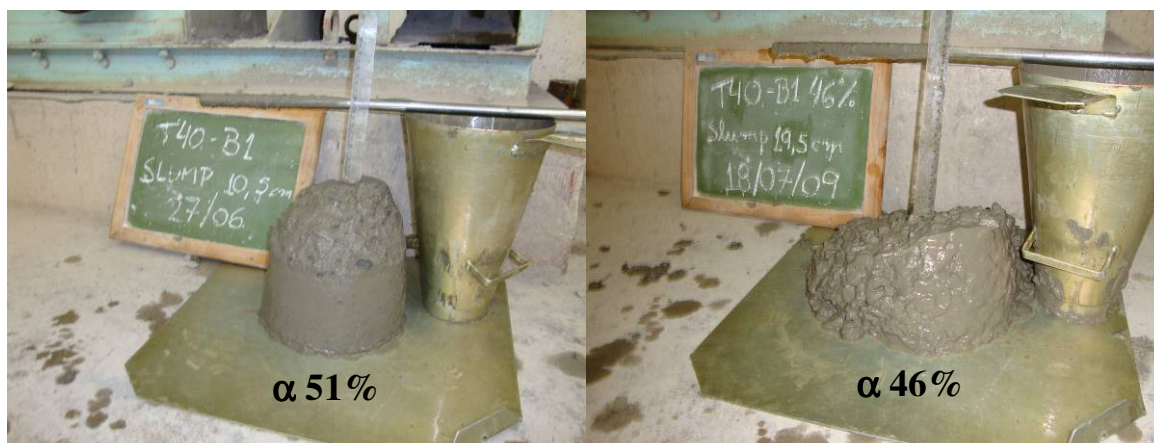
Figura 3-12 Variação da consistência do concreto ao variar o teor de argamassa
